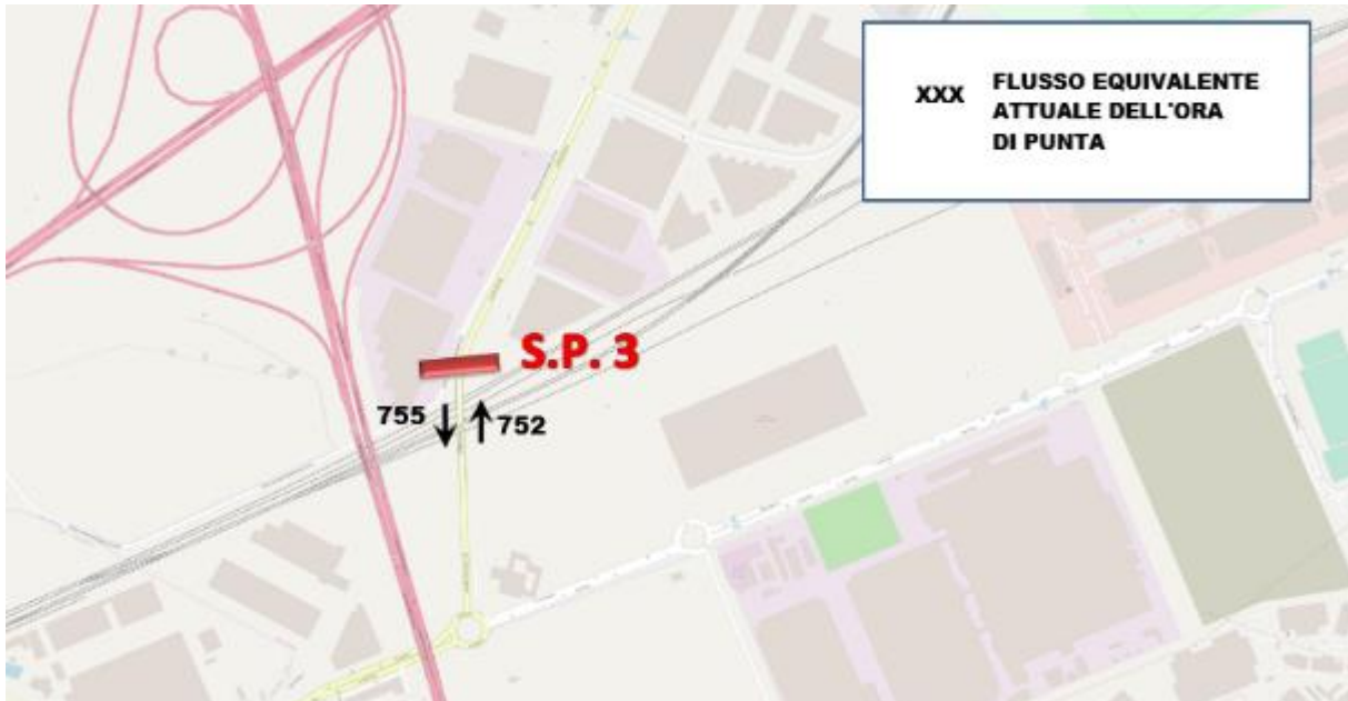
Figura 78: Stato Attuale: flussi totali transitanti lungo strada Cebrosa nord – S.P. 3
