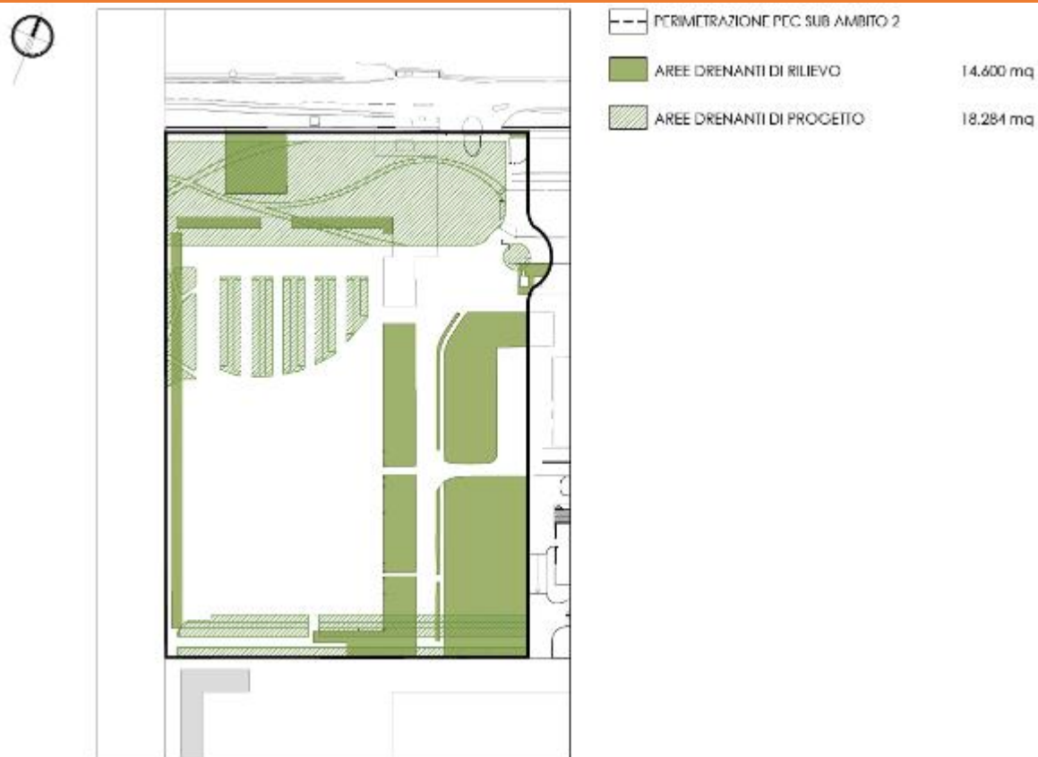
Figura 64: Planimetria dello stato di fatto con il confronto delle aree drenanti esistenti e di progetto (Elaborazione Studio 421)
