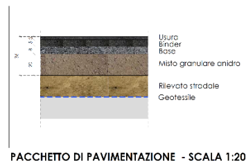
PACCHETTO DI PAVIMENTAZIONE - SCALA 1:20
