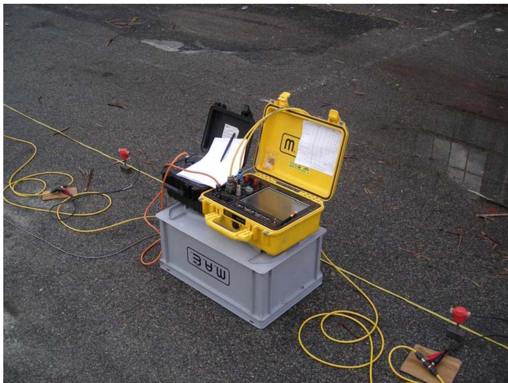
**Foto 1 e 2:** Esecuzione di prospezione sismica MASW D (sotto) e centralina di acquisizione MAE (sotto)
