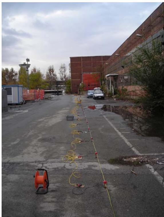
**Foto3 e 4:** Esecuzione di prospezione sismica MASW C (sopra) e MASW B (sotto)
