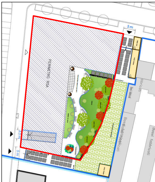
In rosso: individuazione della sagoma dell'edificio RSA e delle aree esterne destinate alla fruizione da parte degli ospiti.
