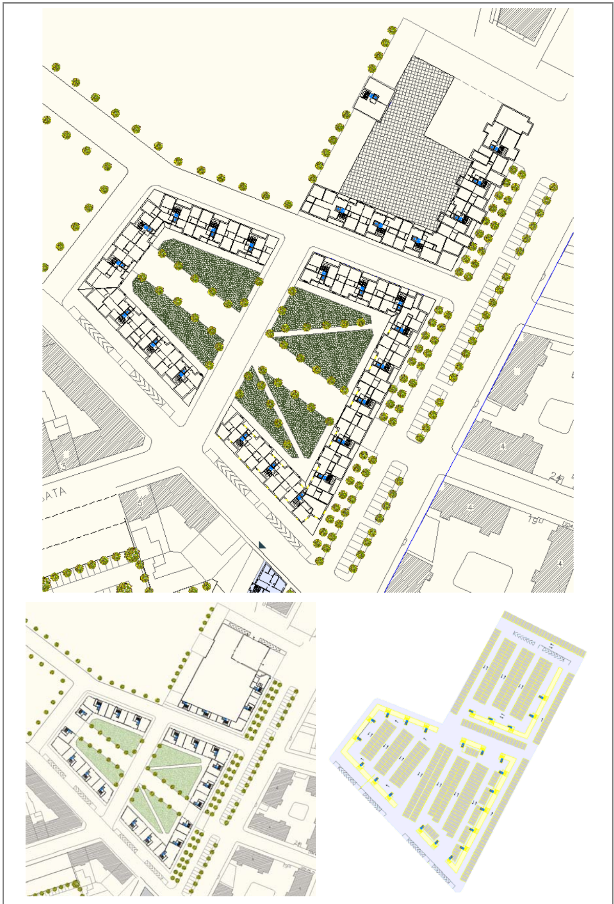
Estratto delle tavole progettuali piano residenziale tipo (sopra), piano terreno (sotto a sinistra) e piano interrato (sotto a destra)
