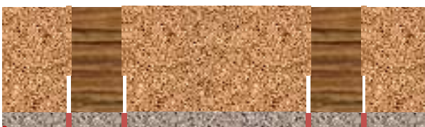
3 - Dopo la sigillatura con materiale elastico verniciabile per consentire la reintegrazione della pellicola pittorica
