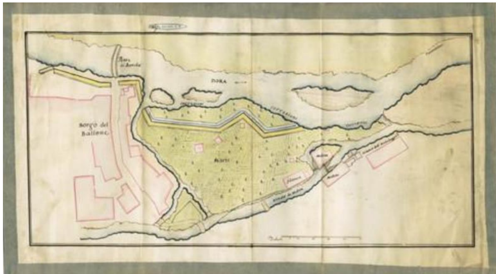
Planimetria del corso della Dora con indicazione delle corrosioni operate dal fiume verso i molini e il canale che li alimenta: circa 1725, ASC, Carte Sciolte, 2240
