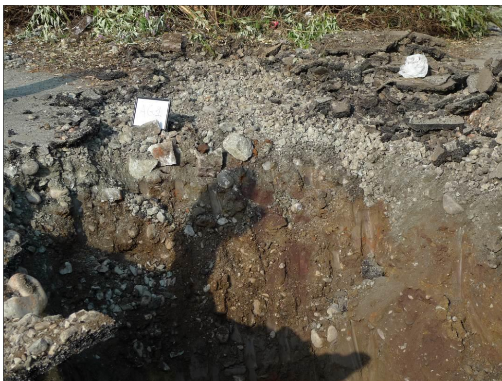
FOTO 15 - Pozzetto AG1 – particolari del 'Riporto con scorie' (colore violaceo)
