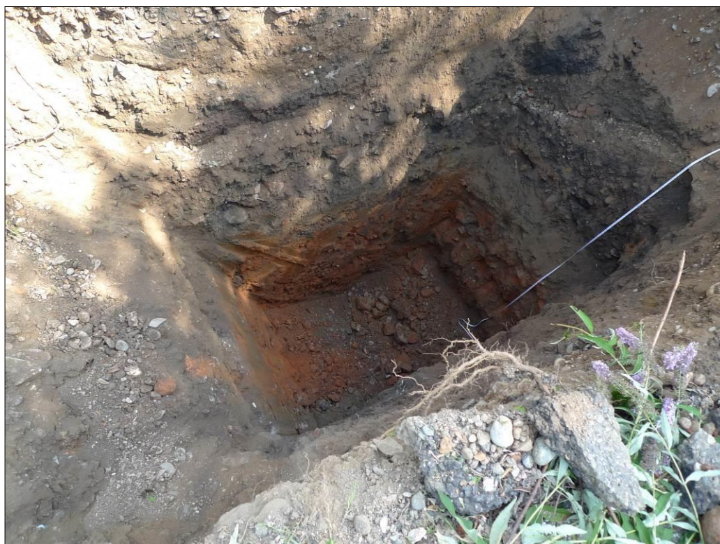
FOTO 19 - Pozzetto AG5 – in evidenza gli orizzonti analizzati
