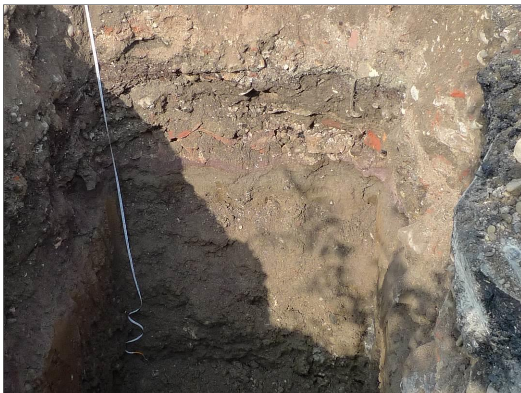
FOTO 17 - Pozzetto AG2 – particolari del 'Riporto con scorie' (colore violaceo)
