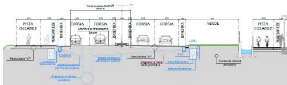
Figura 38 - Sezione nuova configurazione corso Romania Tratto 2
