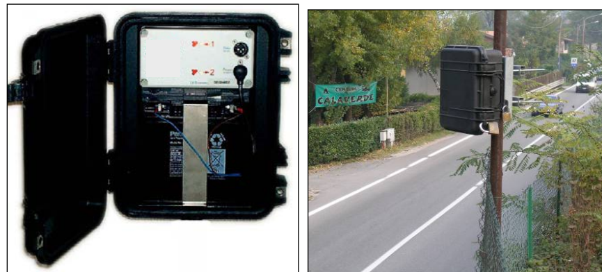
Figura 23 – Le apparecchiature radar di rilevamento utilizzate ed il loro posizionamento
