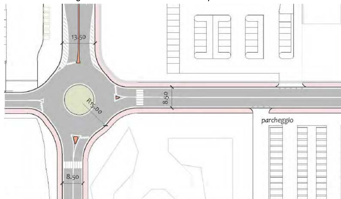
Figura 40 – Rotatoria interna asse perimetrale ovest
