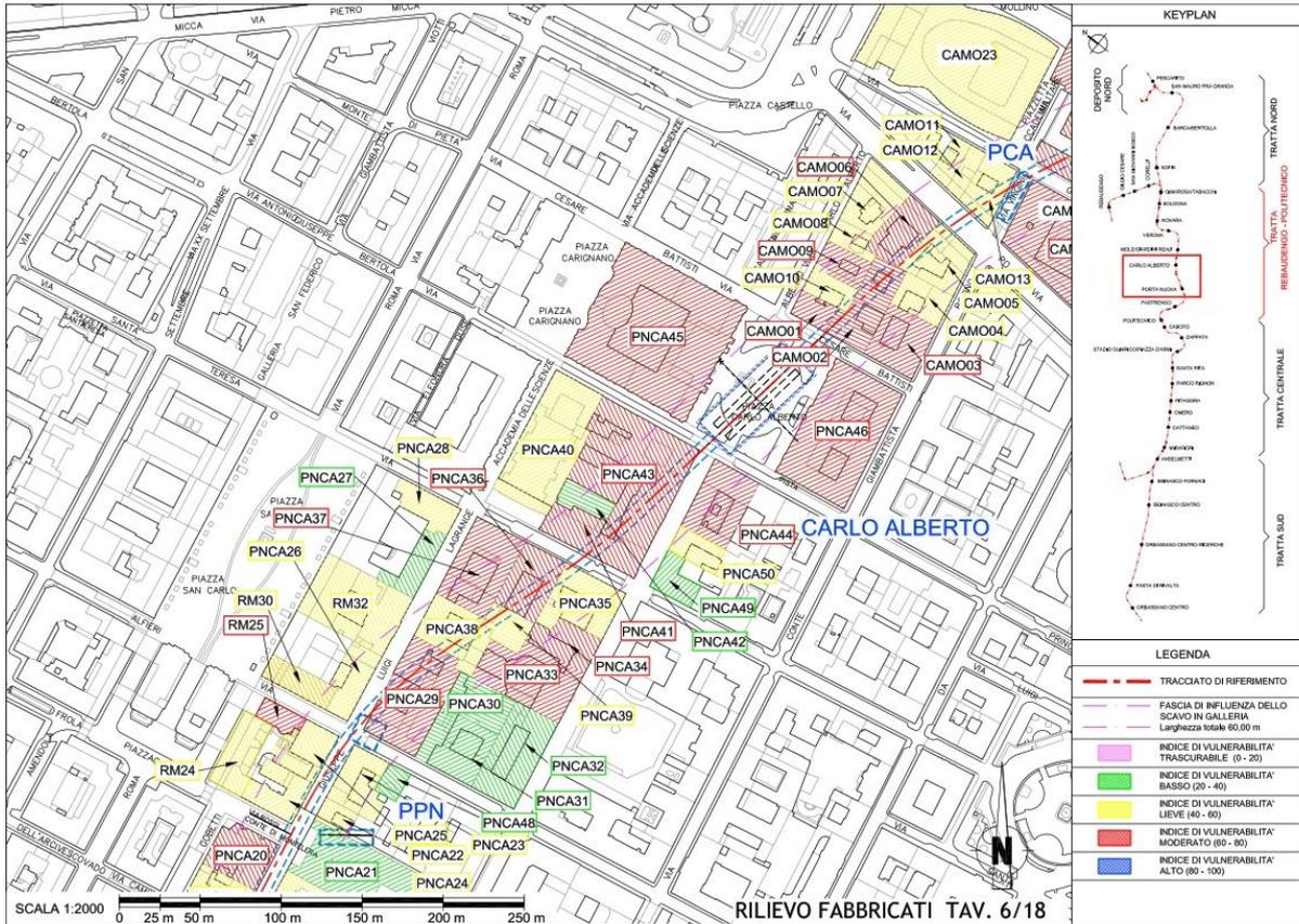
Figura 19. Edifici in prossimità dell'opera in oggetto e relativi Indici di Vulnerabilità (MTL2T1A0D\_FABGENT002)
