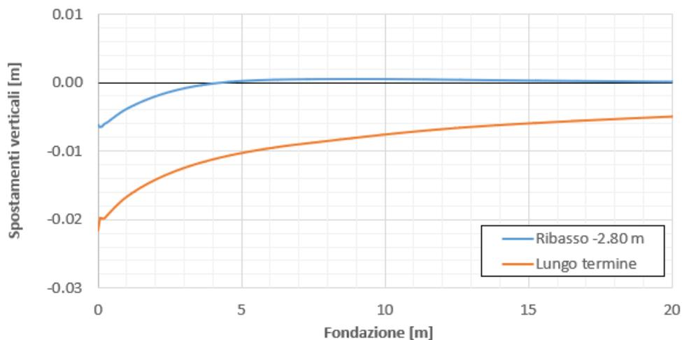
Figura 13. Spostamenti verticali del piano di fondazione (Sezione 1).
