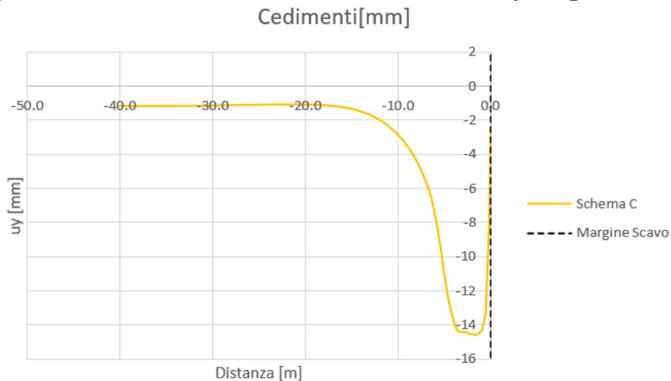
**Figura 17. Subsidenza dovuta alla realizzazione dei micropali degli accessi – Schema C**
