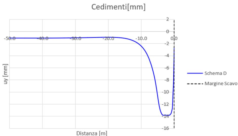
Figura 18. Subsidenza dovuta alla realizzazione dei micropali degli accessi – Schema D
