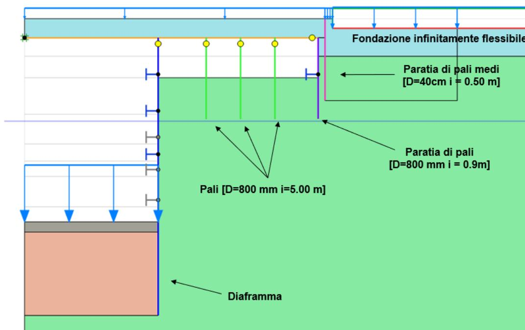
**Figura 9. Modello numerico dell'accesso speciale, Sezione 1.**
