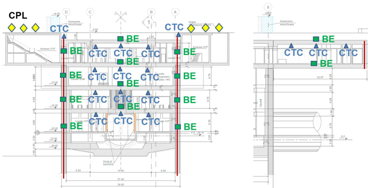
**Figura 22. Schema preliminare di monitoraggio – Sezione tipo**
