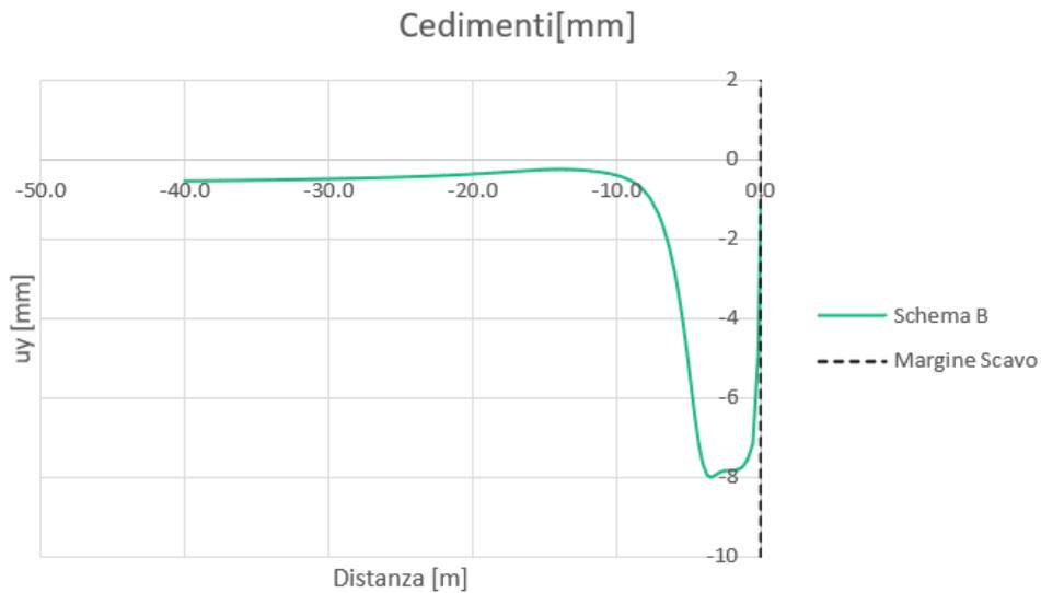
**Figura 16. Subsidenza dovuta alla realizzazione dei micropali degli accessi – Schema B**
