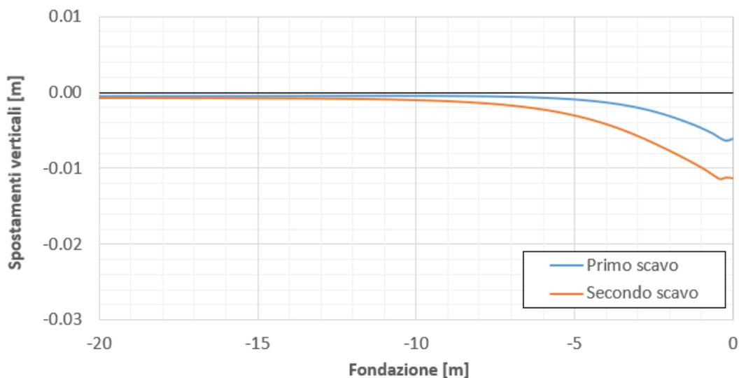
Figura 14. Spostamenti verticali del piano di fondazione (Sezione 2).
