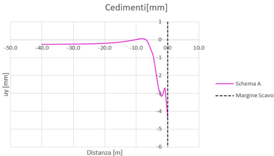
Figura 15. Subsidenza dovuta alla realizzazione dei micropali degli accessi – Schema A
