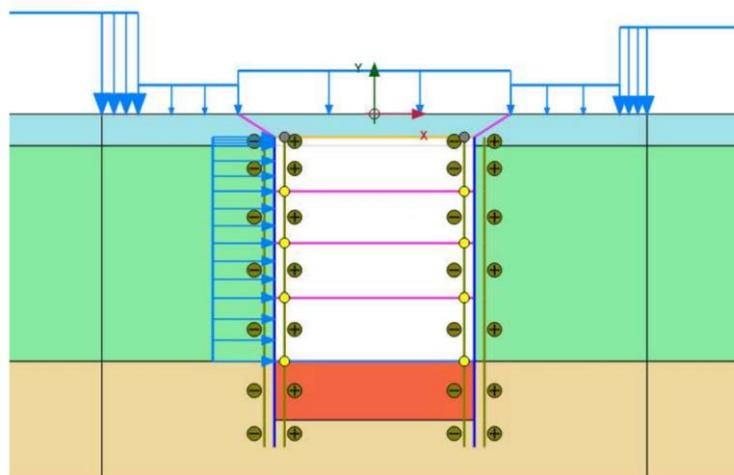
Figura 4. Modello geometrico corpo stazione (Cut&Cover)
