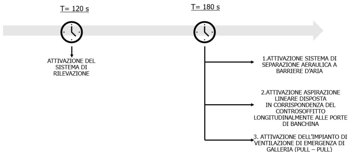
**Figura 2 - Timing attivazione ventilazione Impianti e Sistemi (SCENARIO 1)**
