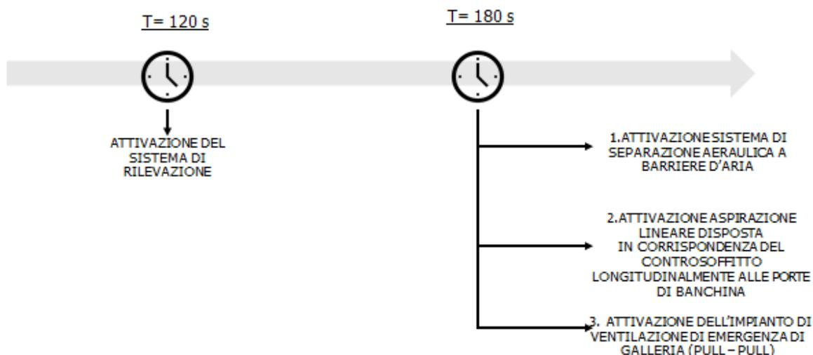
**Figura 6 – Flow chart timing impianti e sistemi**
