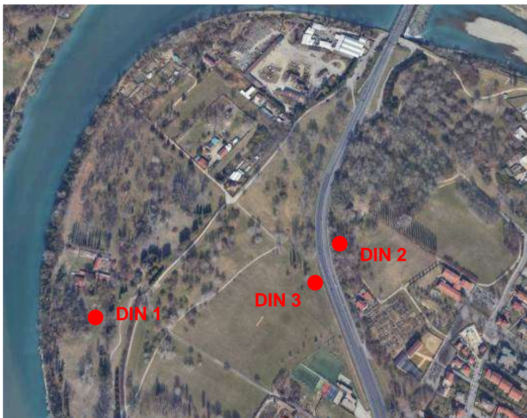
Figura 13 – Ubicazione delle prove penetrometriche
