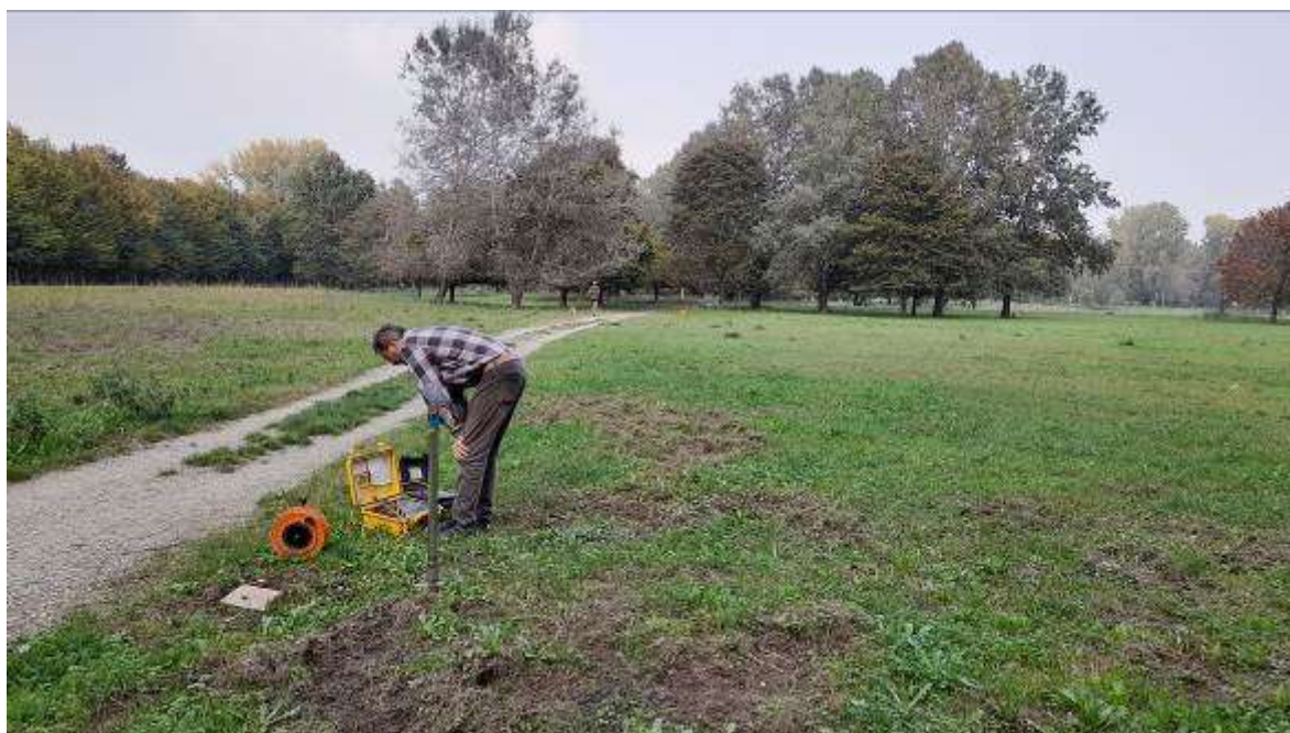
Figura 17 – Esecuzione prova sismica MASW
