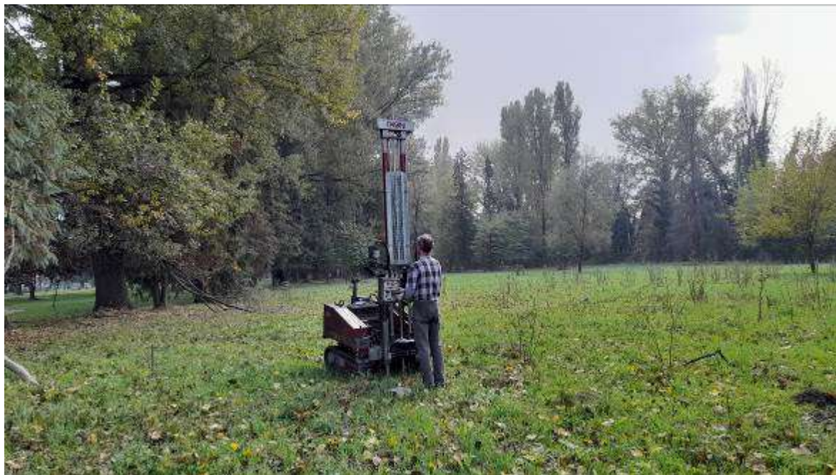
Figura 14 - Esecuzione della prova penetrometrica DIN1
