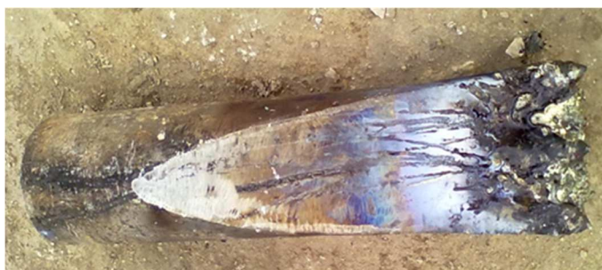
Figura 16. Tipica punta "a becco di flauto", modificata con speciali picchi al carburo di tungsteno.
