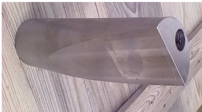
Figura 15. Tipico utensile di perforazione "a becco di flauto", in gergo chiamato jetting bit.
