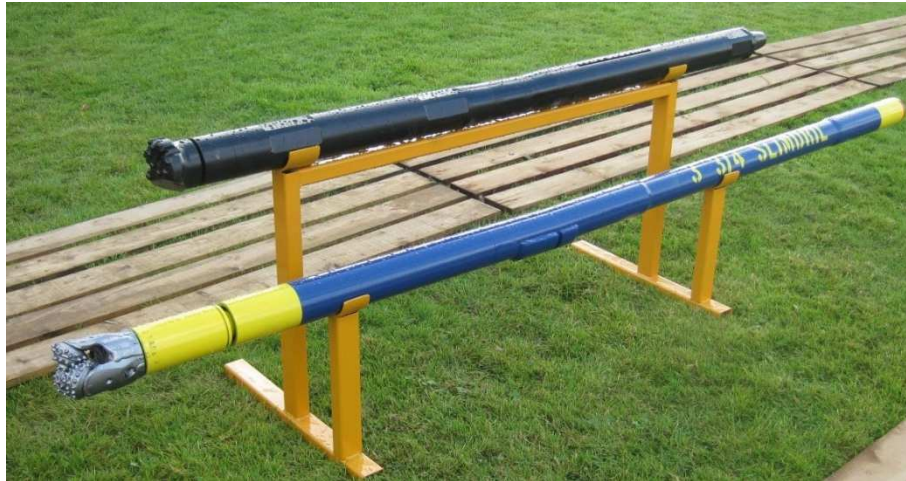
Figura 18. Tipico downhole mud motor.
