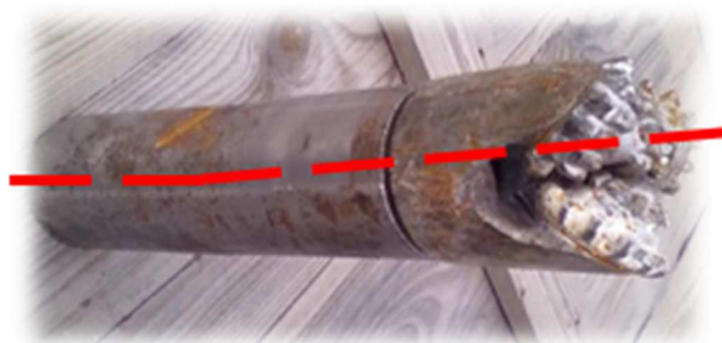
Figura 17. Tipico assemblaggio di tricono su bent sub .
