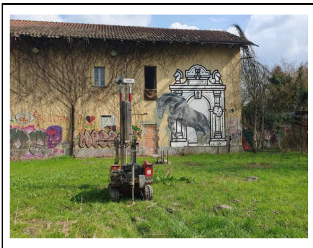
Foto 5: Posizionamento prova penetrometrica dinamica DPSH 5.
