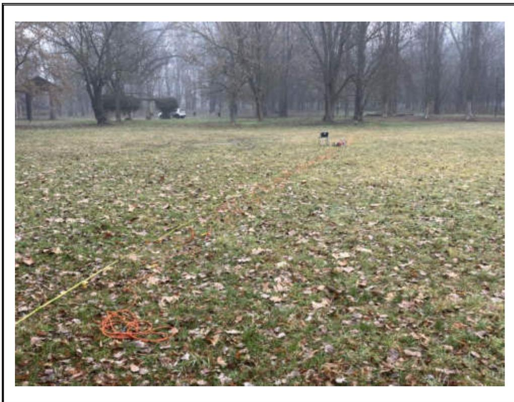
**Foto 16:** Particolare stendimento prova geofisica MASW 2.
