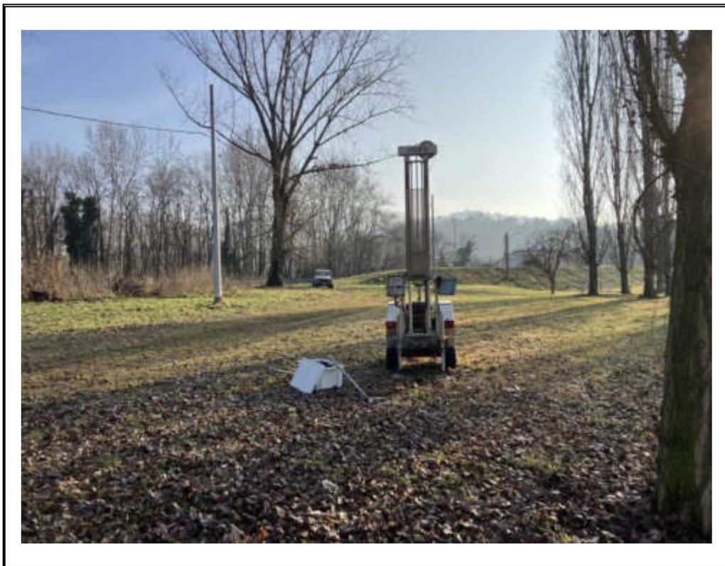
**Foto 9:** Postazione prova penetrometrica DPSH 1.
