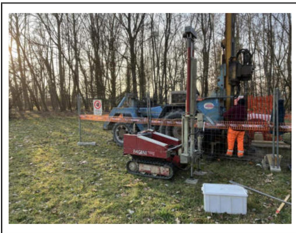
**Foto 14:** Postazione prova penetrometrica DPSH 6 e sondaggio CAR2.
