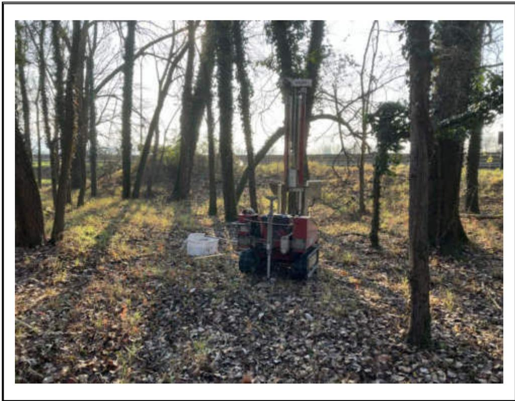
**Foto 11** Postazione prova penetrometrica DPSH 3.
