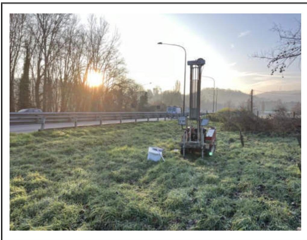
**Foto 10:** Postazione prova penetrometrica DPSH 2.
