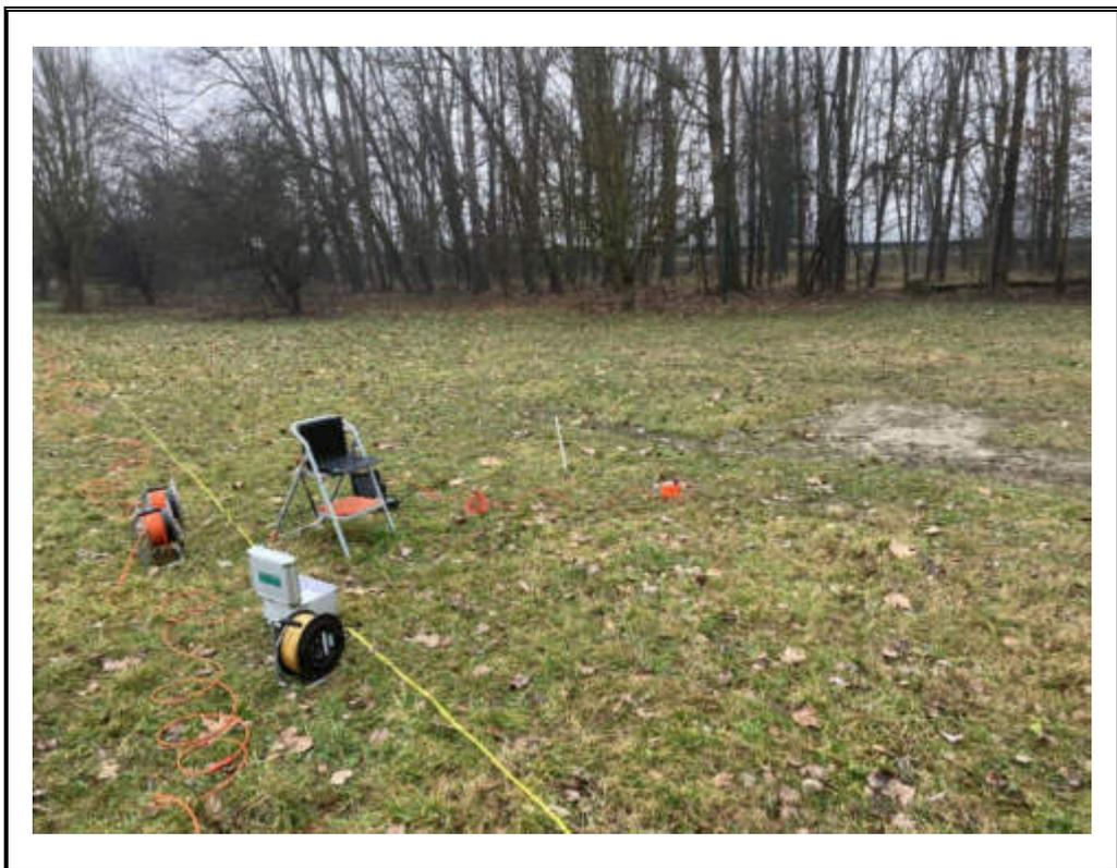
**Foto 18:** Particolare prova geofisica HVSR 4.
