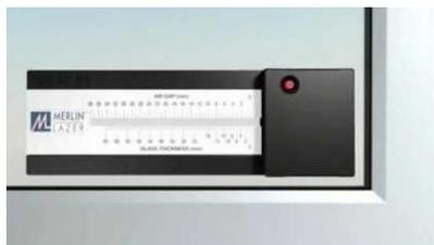
Lo strumento, particolarmente semplice e preciso, permette misure accurate sul vetro e sulle vetrocamera fino a 3 camere. Lo strumento può misurare le seguenti tipologie di vetro: vetro semplice piano; vetro a 1, 2, 3 camere d'aria; vetro camera con pellicola PVB; vetro stratificato.
