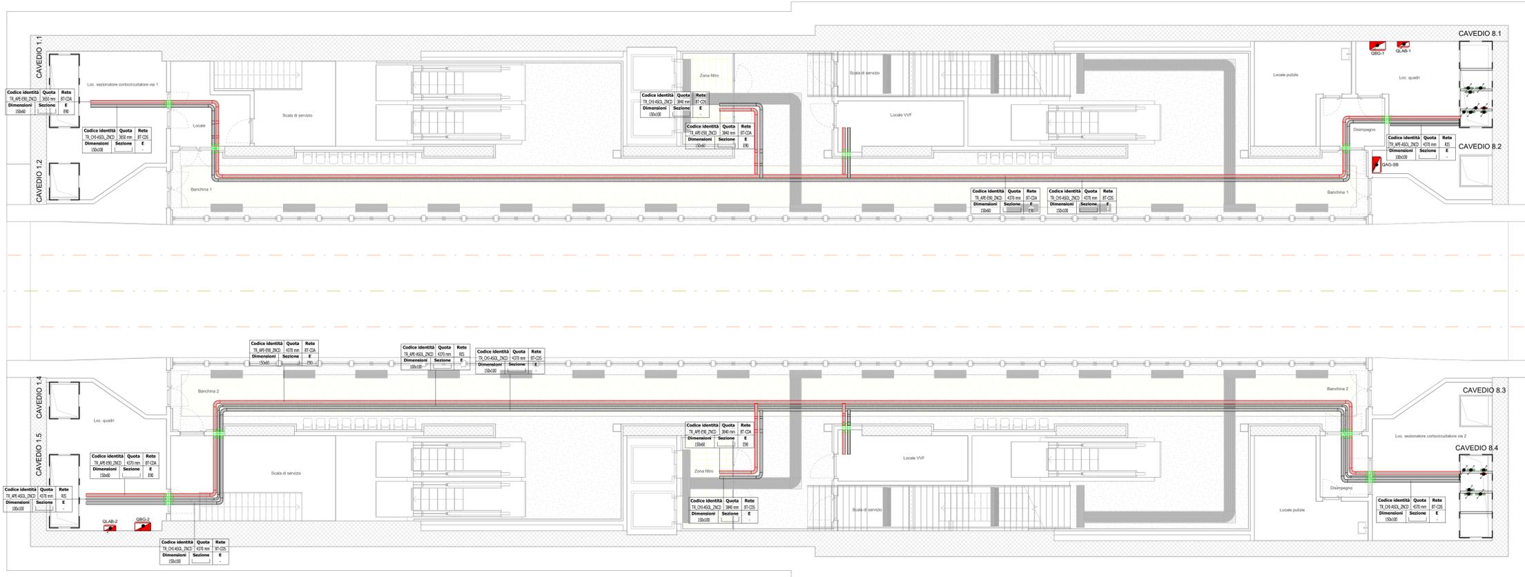
1 Impianto Segnalamento/Automazione - Vie Cavi Pianta Piano banchina
