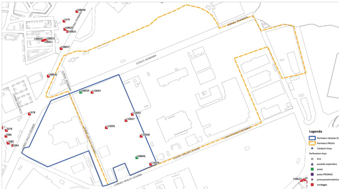
Figura 36: Perforazioni realizzate da Arpa Piemonte e classificate nella Banca Dati Geotecnica (Dati Arpa Piemonte)
