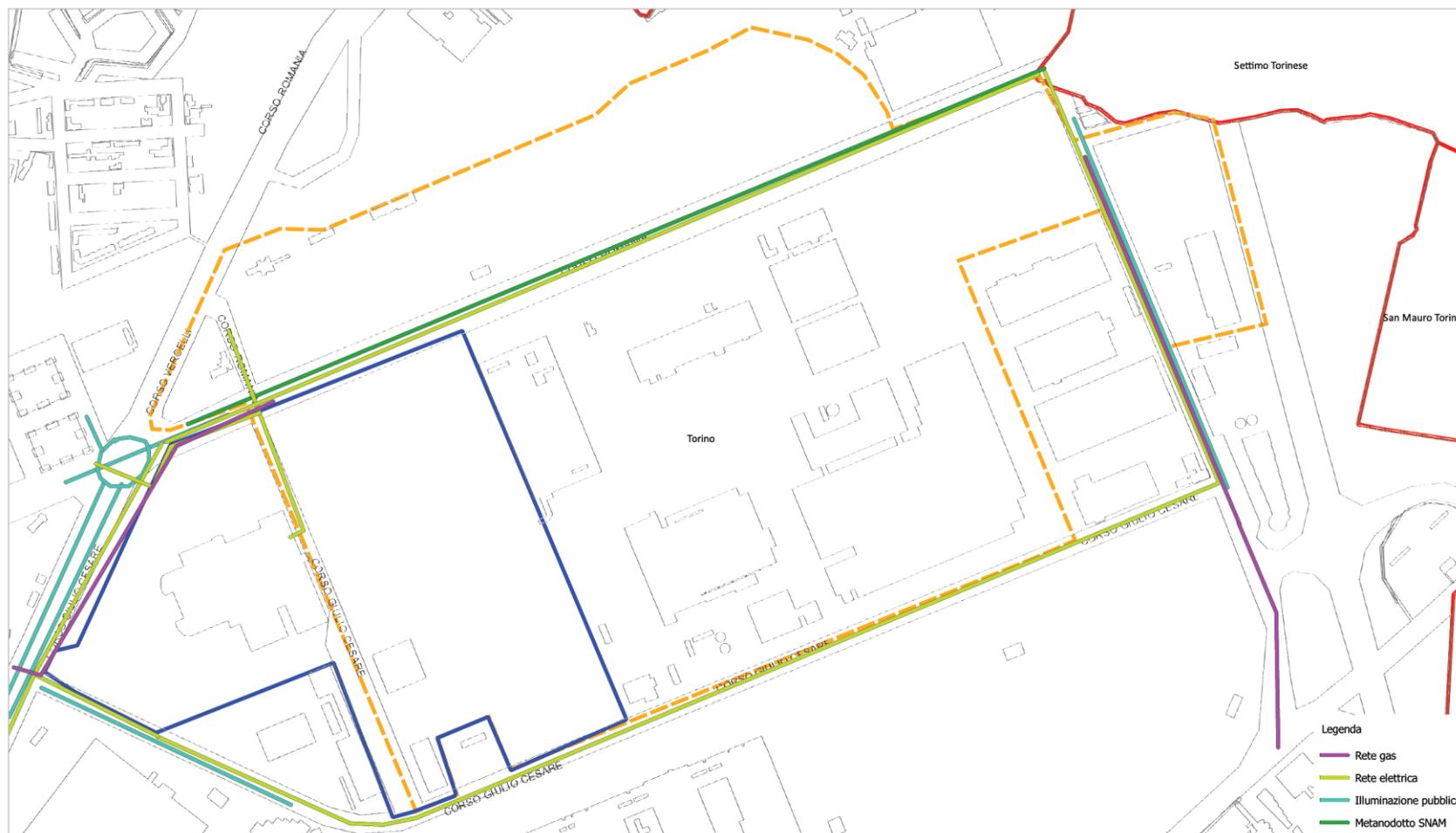
Figura 67: Rilievo sottoservizi esistenti (Rete gas- rete elettrica- illuminazione pubblica- Metanodotto SNAM)
