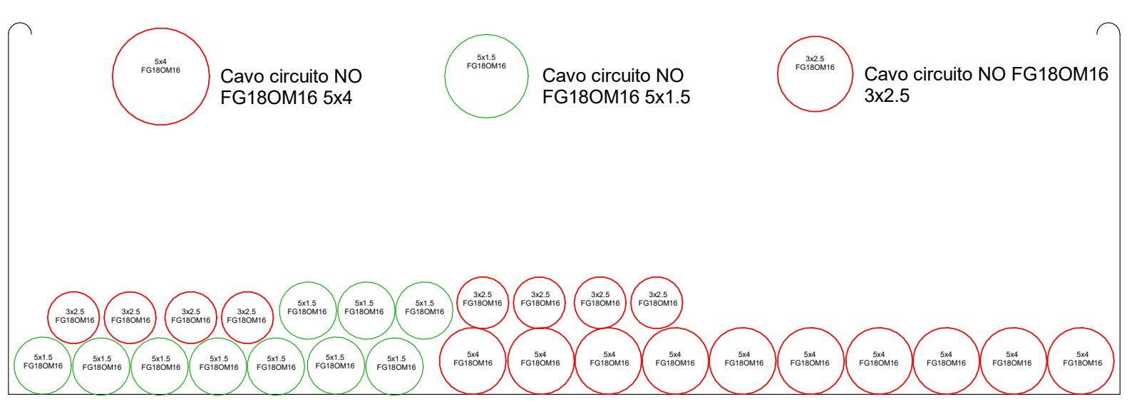
P Riempimento cavi uscita alimentazione elettrica NO - Fuori scala
