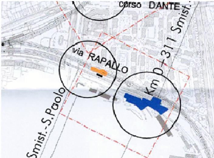
L'intervento prevede la realizzazione di un'area Triage in via Rapallo con accesso da scala metallica da realizzarsi su proprietà ferroviaria, e un piazzale di emergenza con annesso fabbricato tecnologico PGEP (dimensioni 36,90 x 7,60 h. 4,42) su una superficie recintata di mq 1.670 con accesso da via Forlanini e Via Camogli. È inoltre prevista la realizzazione di un piano a raso sui binari per l'utilizzo del mezzo bimodale dei V.V.F.
