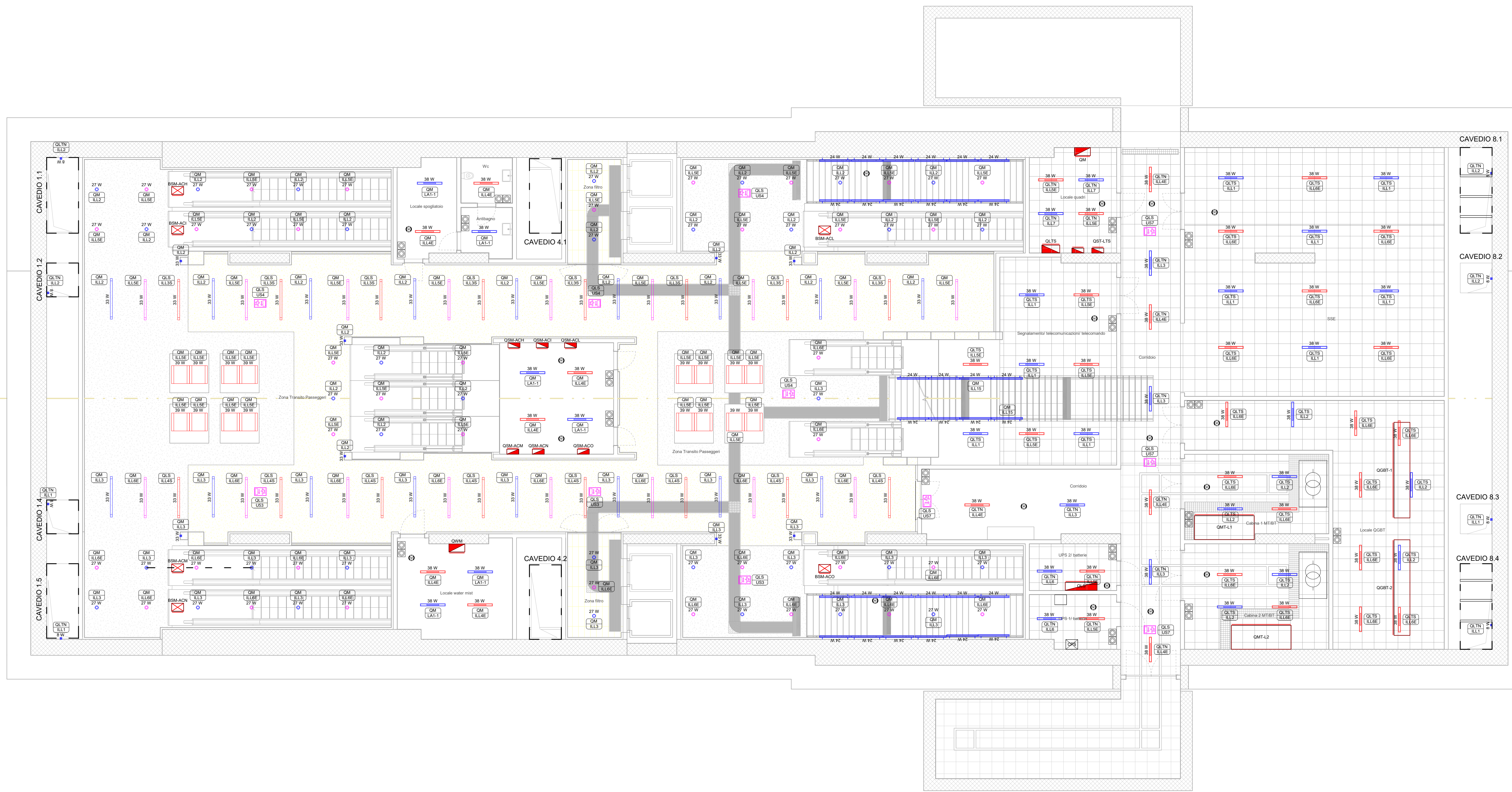
1 Impianto Illuminazione - Pianta Piano mezzanino 1:100
