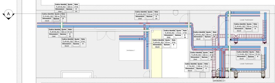
1 Impianto di Forza Motrice - Piano primo interrato (livello -1) - Layout vie cavi
