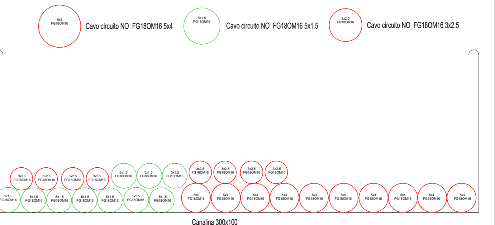
P Riempimento cavi uscita alimentazione elettrica NO - Fuori scala
