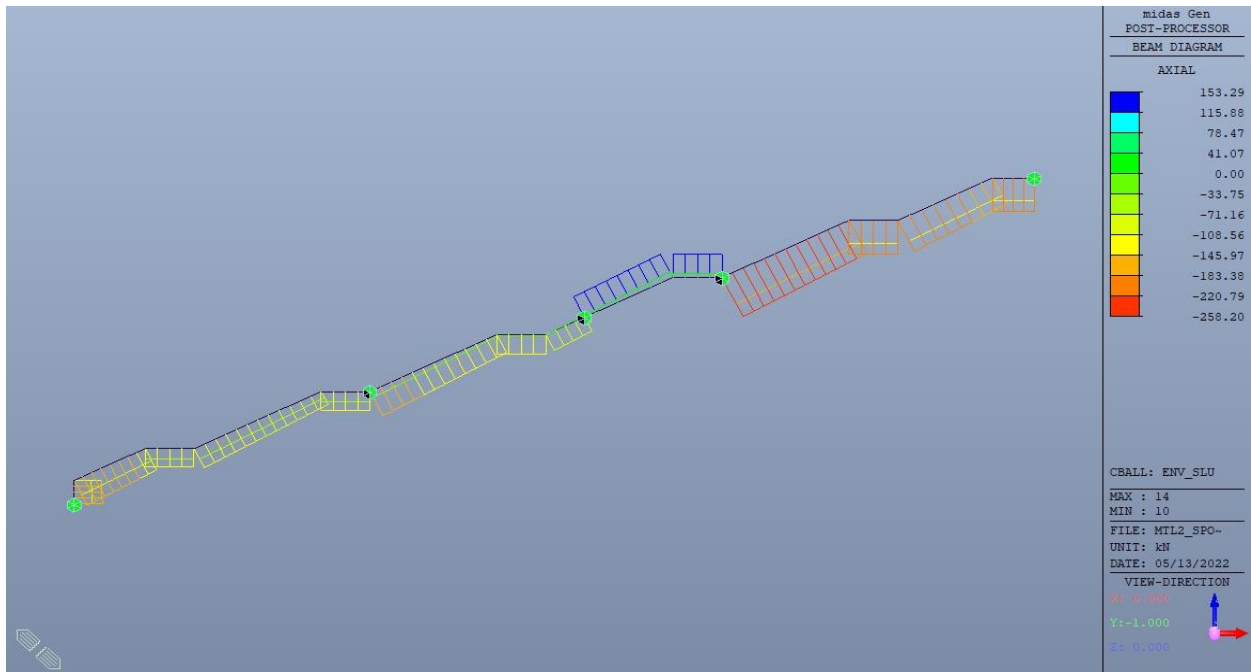
Figura 320. Scalone di accesso passeggeri – Involucro sforzo normale N - SLU
