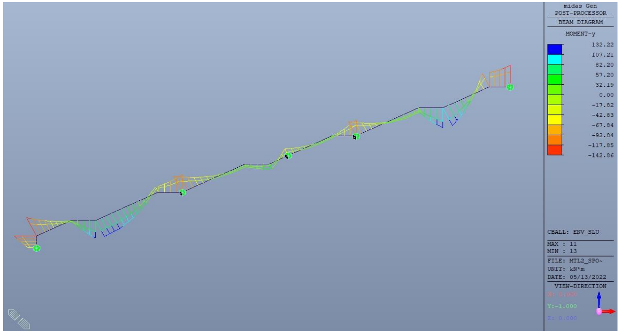
Figura 318. Scalone di accesso passeggeri – Involuppo momento M_y - SLU
