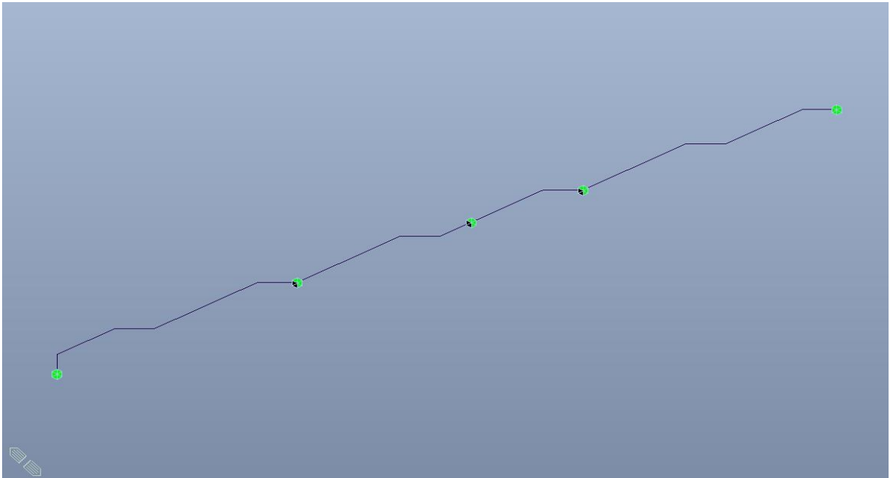
Figura 317. Scalone di accesso passeggeri – Schema statico
