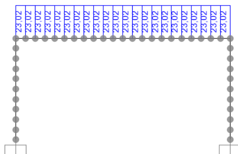
Figura 143. Trazione agente in soletta conseguente al ritiro
