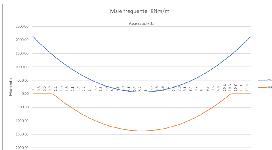
Figura 135.Momento flettente (SLE Frequente)
