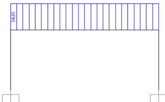
Figura 127. Trazione agente in soletta conseguente al ritiro
