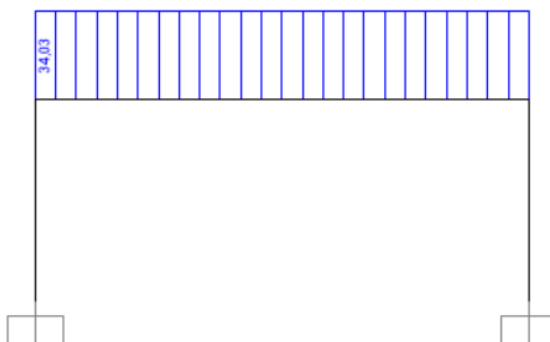
Figura 111. Trazione agente in soletta conseguente al ritiro
