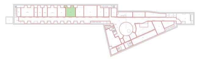
Il locale ospita l'officina accessori interni treni e sarà dotato di un sistema di ventilazione di emergenza dimensionato in base alla norma UNI 9494-2; facendo riferimento alla superficie del locale ( $201 \text{ m}^2$ ) e al volume ( $919 \text{ m}^3$ ), la portata totale minima che il sistema di evacuazione fumi deve garantire risulta essere pari a  $23.335 \text{ m}^3$ /h.
