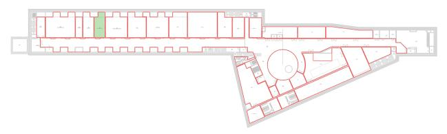
Il locale ospita la cabina lavaggio ricambi e sarà dotato di un sistema di ventilazione di emergenza dimensionato in base alla norma UNI 9494-2; facendo riferimento alla superficie del locale (98 m²) e al volume (450 m³), la portata totale minima che il sistema di evacuazione fumi deve garantire risulta essere pari a 11.430 m³/h.
