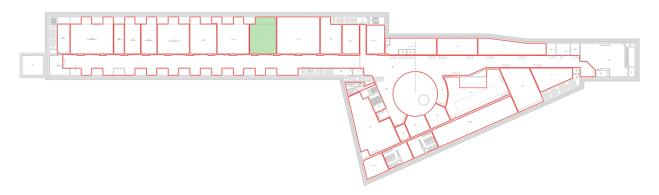
Il locale ospita l'officina armamento e sarà dotato di un sistema di ventilazione di emergenza dimensionato in base alla norma UNI 9494-2; facendo riferimento alla superficie del locale (167  $m^2$ ) e al volume (763  $m^3$ ), la portata totale minima che il sistema di evacuazione fumi deve garantire risulta essere pari a 19.370  $m^3$ /h.
