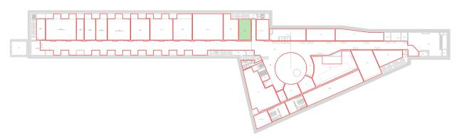
Il locale ospita il magazzino scorte e sarà dotato di un sistema di ventilazione di emergenza dimensionato in base alla norma UNI 9494-2; facendo riferimento alla superficie del locale ( $106 \, \text{m}^2$ ) e al volume ( $484 \, \text{m}^3$ ), la portata totale minima che il sistema di evacuazione fumi deve garantire risulta essere pari a  $12.286 \, \text{m}^3$ /h.
