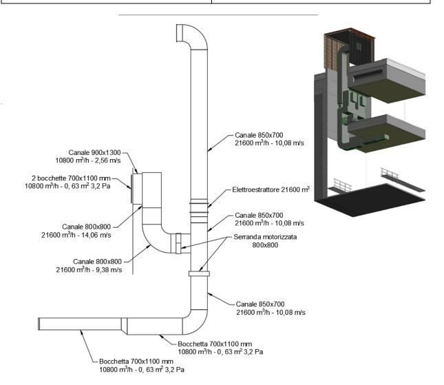
Per garantire l'affidabilità a livello SIL2 (EN61508), nel normale funzionamento la portata di estrazione sarà pari a 21.600 m³/h. In caso di guasto contemporaneo di tre estrattori la portata di ogni singola macchina raggiungerà 30.857 m³/h per garantire la portata complessiva richiesta.
