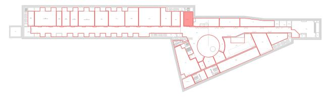
All'interno di questo locale sono ospitati i ventilatori di estrazione fumi al servizio del piano primo interrato.
