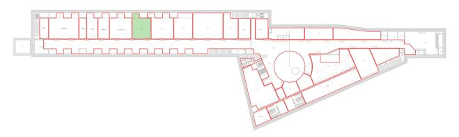
Il locale ospita l'officina saldatura e sarà dotato di un sistema di ventilazione di emergenza dimensionato in base alla norma UNI 9494-2; facendo riferimento alla superficie del locale ( $166 \text{ m}^2$ ) e al volume ( $762 \text{ m}^3$ ), la portata totale minima che il sistema di evacuazione fumi deve garantire risulta essere pari a  $19.365 \text{ m}^3$ /h.
