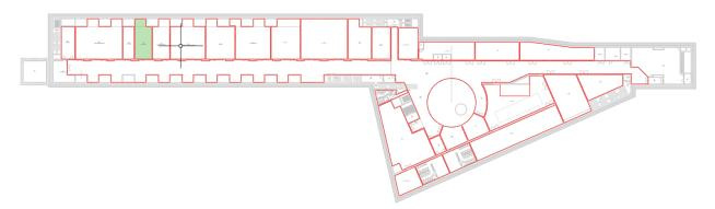
Il locale ospita l'officina batterie, in base alle considerazioni già esposte nei paragrafi precedenti, il vano sarà dotato di un sistema di ventilazione di emergenza dimensionato in base alla norma UNI 9494-2.
