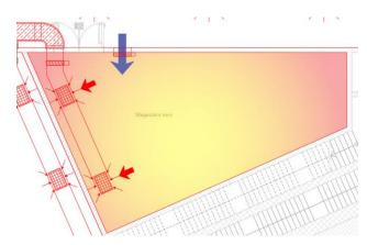
Il riscontro dell'aria esterna sarà garantito mediante l'apertura di una serranda motorizzata che provvederà ad aspirare direttamente dalla zona corridoio
