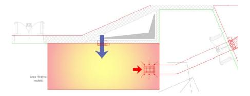
L'ingresso dell'aria esterna di riscontro sarà garantita mediante l'apertura di una serranda motorizzata comunicante con il cavedio verticale adiacente il locale.
