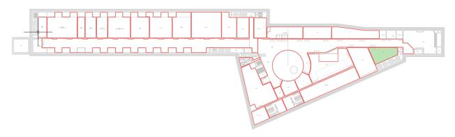
Il locale ospita il magazzino treni e sarà dotato di un sistema di ventilazione di emergenza dimensionato in base alla norma UNI 9494-2; facendo riferimento alla superficie del locale (141  $m^2$ ) e al volume (644  $m^3$ ), la portata totale minima che il sistema di evacuazione fumi deve garantire risulta essere pari a 16.368  $m^3/h$ .
