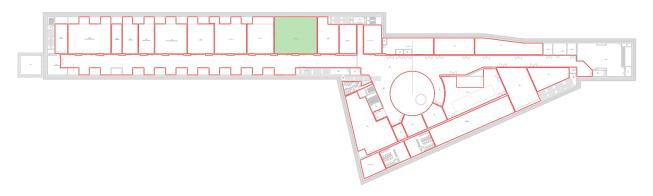
Il locale ospita l'officina elettromeccanica e sarà dotato di un sistema di ventilazione di emergenza dimensionato in base alla norma UNI 9494-2; facendo riferimento alla superficie del locale (334  $m^2$ ) e al volume (1529  $m^3$ ), la portata totale minima che il sistema di evacuazione fumi deve garantire risulta essere pari a 38.839  $m^3$ /h.
