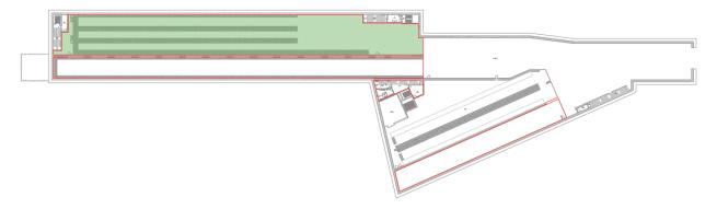
In tale zona il risultato dell'analisi CFD richiede il l'estrazione di una portata complessiva pari a  $81 \text{ m}^3/\text{s}$  (291.600 m³/h).
