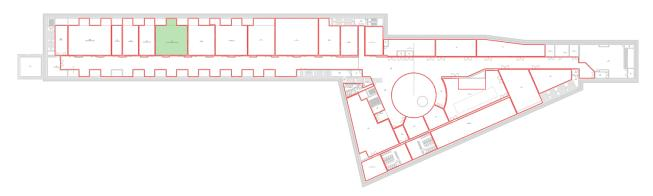
Il locale ospita l'officina sistemi idrici e pneumatici e sarà dotato di un sistema di ventilazione di emergenza dimensionato in base alla norma UNI 9494-2; facendo riferimento alla superficie del locale ( $201 \text{ m}^2$ ) e al volume ( $919 \text{ m}^3$ ), la portata totale minima che il sistema di evacuazione fumi deve garantire risulta essere pari a  $23.335 \text{ m}^3$ /h.
