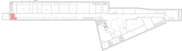
All'interno di questo locale sono ospitate le apparecchiature relative al sistema di pompaggio antincendio, idranti, sprinkler e water mist. In relazione alla tipologia di attività svolte all'interno, alle apparecchiature contenute e all'affollamento previsto, il locale non sarà protetto da un sistema di ventilazione di emergenza.
