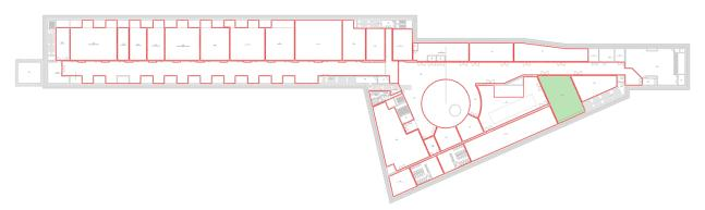
Il locale ospita il magazzino di linea e sarà dotato di un sistema di ventilazione di emergenza dimensionato in base alla norma UNI 9494-2; facendo riferimento alla superficie del locale ( $244 \, \text{m}^2$ ) e al volume ( $1.116 \, \text{m}^3$ ), la portata totale minima che il sistema di evacuazione fumi deve garantire risulta essere pari a  $28.336 \, \text{m}^3$ /h.
