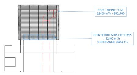
Il ventilatore sarà posizionato ad una quota tale da risultare facilmente accessibile per manutenzione da quota primo livello interrato.
