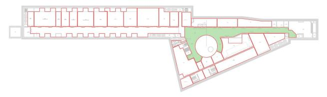
Il corridoio tecnico 2 sarà dotato di un sistema di ventilazione di emergenza dimensionato in base alla norma UNI 9494-2; facendo riferimento alla superficie del locale (905 m²) e al volume (4.144 m³), la portata totale minima che il sistema di evacuazione fumi deve garantire risulta essere pari a 105.260 m³/h.
