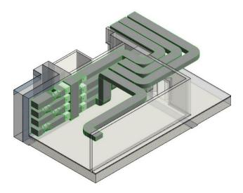
I medesimi ventilatori, mediante una serie di canalizzazioni dedicate intercettate da un sistema di serrande motorizzate, consentiranno l'estrazione dei gas in ambiente a seguito dell'intervento dei sistemi di spegnimento a gas inerte e water mist nei locali elettrici.
