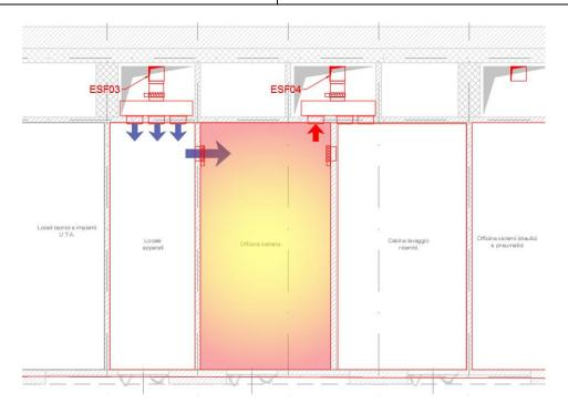
Infine, in caso di incendio all'interno del locale cabina lavaggio ricambi, l'estrazione dei fumi sarà garantita dal funzionamento dell'estrattore ESF04 tramite due bocchette, mentre il riscontro dell'aria immessa sarà assicurato dal ventilatore ESF03 e dall'apertura delle due serrande di comunicazione dei canali.
