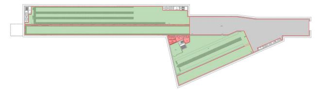
Volendo riassumere graficamente quanto riportato nei paragrafi precedenti, facendo riferimento alla figura precedente, le aree campite in verde saranno dotate di sistemi di ventilazione di emergenza, le aree campite in rosso non saranno dotate di un impianto dedicato. Il sistema di ventilazione di emergenza dell'area campita in grigio, invece, sarà il medesimo della linea, ed esula dalla trattazione del presente documento.
