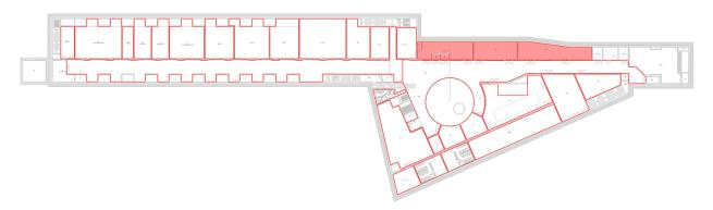
All'interno di questi locali (cabina MT/BT, locale quadri e locale SSE sono ospitate le attrezzature elettriche al servizio del deposito e della linea. In relazione alla tipologia di attività svolte all'interno e al particolare sistema di spegnimento adottato (Water mist / saturazione di gas inerte) i locali non saranno protetti da un sistema di ventilazione di emergenza.
