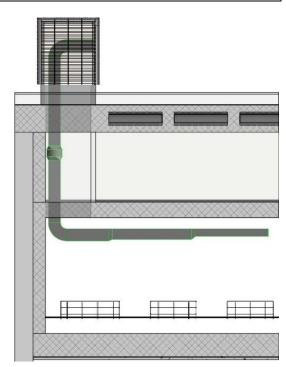
L'aria di riscontro, che dovrà essere immessa per compensare i fumi estratti, verrà aspirata naturalmente attraverso una serie di griglie corredate di serranda motorizzata che saranno posizionate alla base dell'additamento tecnico che maschererà i canali e le griglie di espulsione
