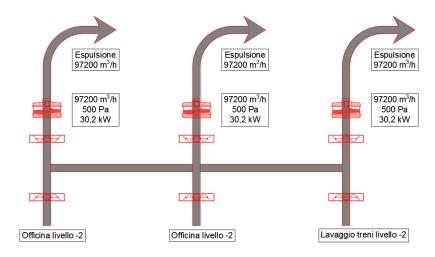
Fisicamente, lo schema illustrato sarà realizzato sovrapponendo i ventilatori di estrazione e realizzando due collettori verticali.
