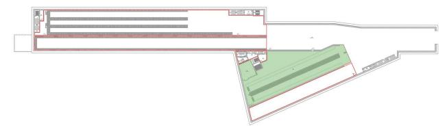
In tale zona il risultato dell'analisi CFD richiede il l'estrazione di una portata complessiva pari a  $63,6 \text{ m}^3/\text{s}$  ( $228.960 \text{ m}^3/\text{h}$ ).
