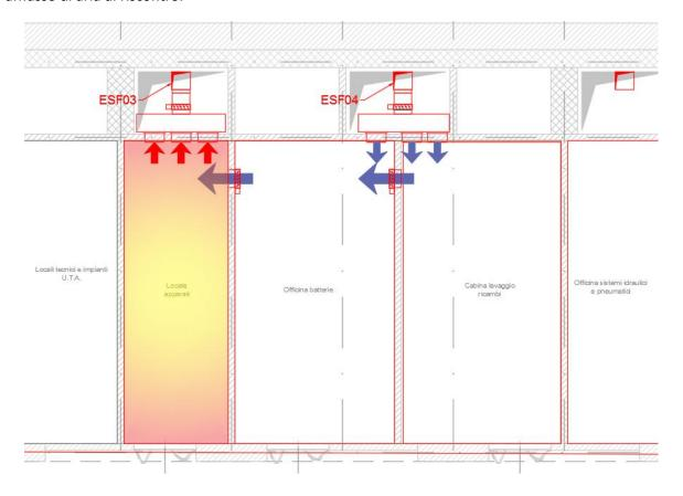
In caso di incendio all'interno dell'officina batteria, invece, il ventilatore ESF04 provvederà ad estrarre i fumi mediante la bocchetta (dotata di serranda motorizzata) posizionata nel locale, mentre le altre due bocchette saranno mantenute chiuse, così come la serranda di comunicazione con il locale cabina lavaggio ricambi. L'aria di riscontro sarà garantita grazie al ventilatore ESF03 e all'apertura della serranda di comunicazione con il locale apparati.
