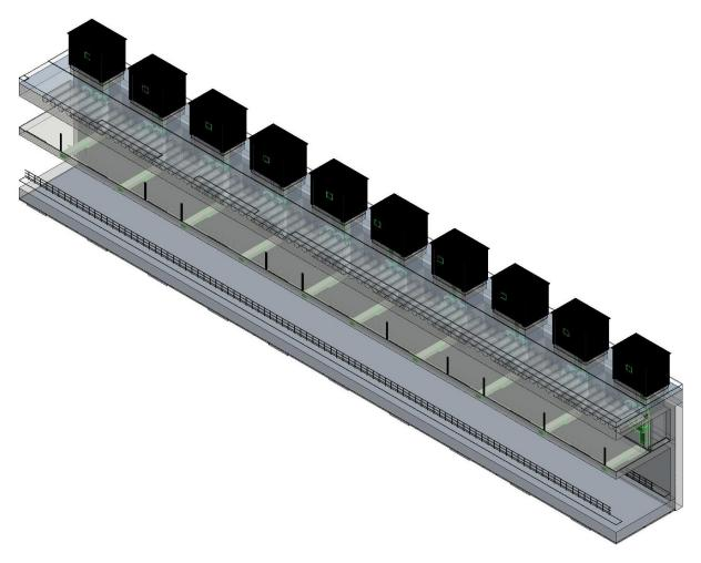
In modo analogo, la ventilazione di emergenza per il parcheggio due binari sarà affidato ad un sistema costituito da dieci ventilatori a ciascuno dei quali farà capo una rete di canalizzazioni corredata da due bocchette di estrazione/immissione.
