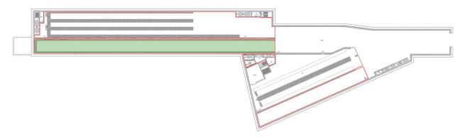
In tale zona il risultato dell'analisi CFD richiede il l'estrazione di una portata complessiva pari a  $60 \text{ m}^3/\text{s}$  (216.000 m³/h).
