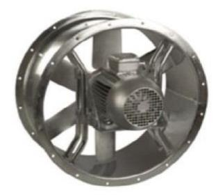
I ventilatori saranno della tipologia "dual purpose", in grado di invertire il senso di rotazione del motore, assolvendo in tal modo sia alla funzione di estrazione fumi, sia alla funzione di immissione aria esterna.
