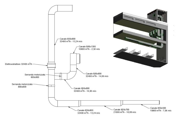
Per garantire l'affidabilità a livello SIL2 (EN61508), nel normale funzionamento la portata di estrazione sarà pari a 32.400 m³/h.
