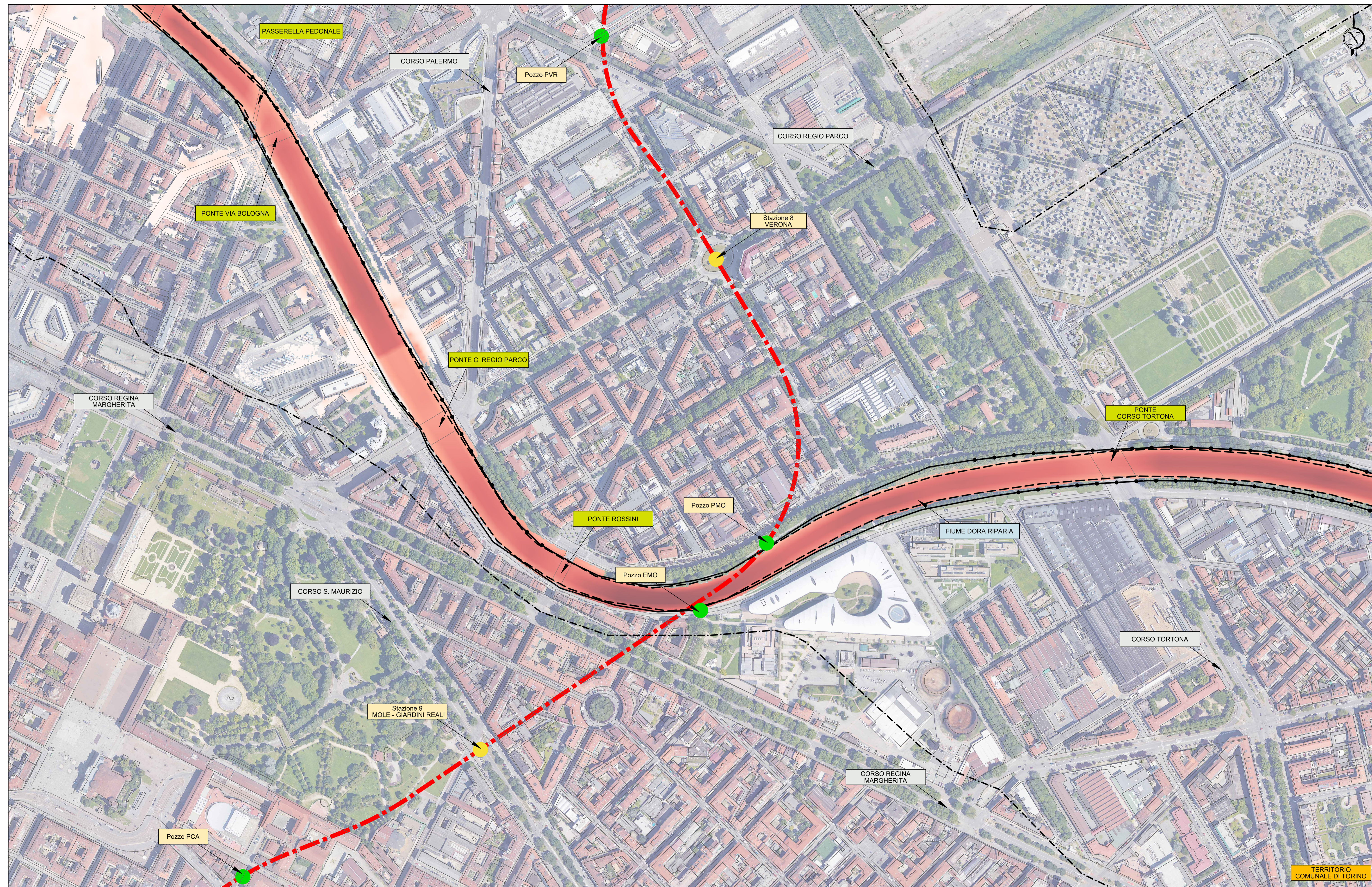
VELOCITA' DI DEFLUSSO MASSIME PER UN EVENTO DI PIENA TR 200 ANNI, IN CONDIZIONI ATTUALI IN ASSENZA DI CASSA DI LAMINAZIONE A MONTE E PARZIALE OSTRUZIONE DEL PONTE DI CORSO REGIO PARCO Base carta: BDTRE Regione Piemonte, Ortofoto Scala 1 : 2.500
