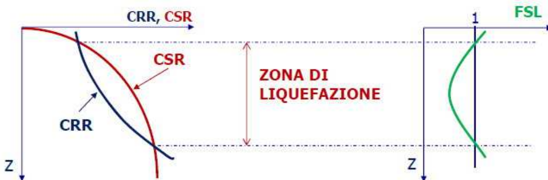
Figura 19. Criterio per il calcolo del pericolo della liquefazione
