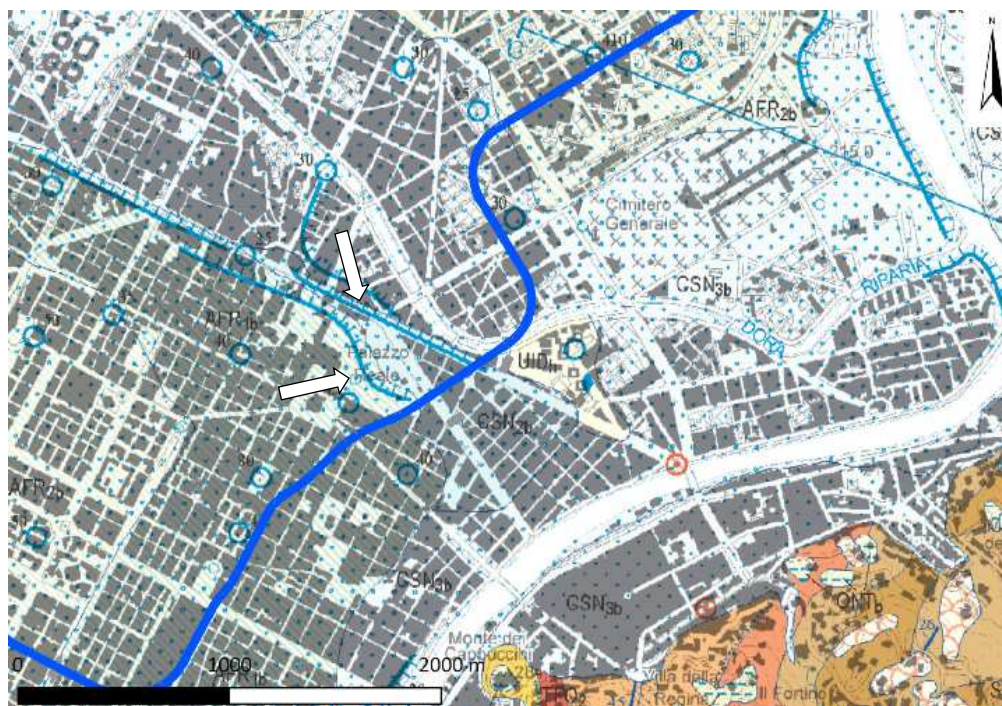
Figura 6. Estratto del Foglio CARG relativo alla zona dell'attraversamento della Dora Riparia. Per la legenda si rimanda alla carta originale. La linea blu rappresenta l'opera in progetto. Le frecce bianche indicano le scarpate descritte nel testo
