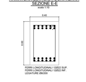
**ARMATURA EDIFICIO FUORI TERRA DETTAGLIO 2**
