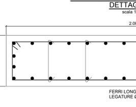
**ARMATURA EDIFICIO FUORI TERRA DETTAGLIO 2**
