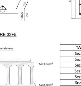
**ARMATURA EDIFICIO FUORI TERRA SEZIONE F-F**
