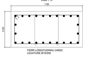
**ARMATURA EDIFICIO FUORI TERRA SEZIONE H-H - PIANO SECONDO**
