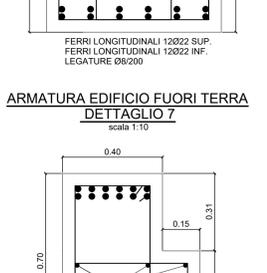
**ARMATURA EDIFICIO FUORI TERRA SEZIONE D-D**
