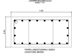
**ARMATURA EDIFICIO FUORI TERRA SEZIONE H-H**
