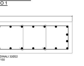
**ARMATURA EDIFICIO FUORI TERRA - SEZIONE LONGITUDINALE**
