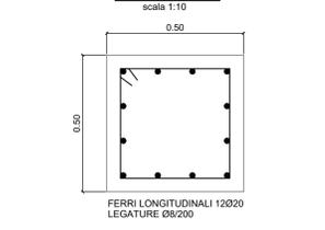
**ARMATURA EDIFICIO FUORI TERRA DETTAGLIO 1**
