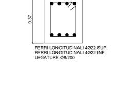
**ARMATURA EDIFICIO FUORI TERRA DETTAGLIO 6**
