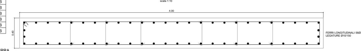
**ARMATURA EDIFICIO FUORI TERRA - DETTAGLIO 3 - PIANO TERRA**
