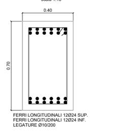
**ARMATURA EDIFICIO FUORI TERRA DETTAGLIO 7**
