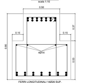
**ARMATURA EDIFICIO FUORI TERRA DETTAGLIO 3**
