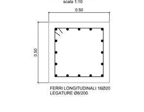
**ARMATURA EDIFICIO FUORI TERRA DETTAGLIO 1**
