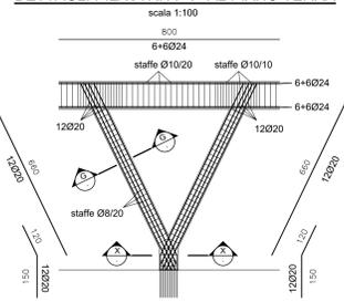
**DETTAGLIO PILASTRO A "V" SEZIONE X-X**
