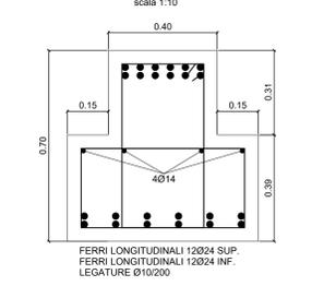
**ARMATURA EDIFICIO FUORI TERRA DETTAGLIO 4**
