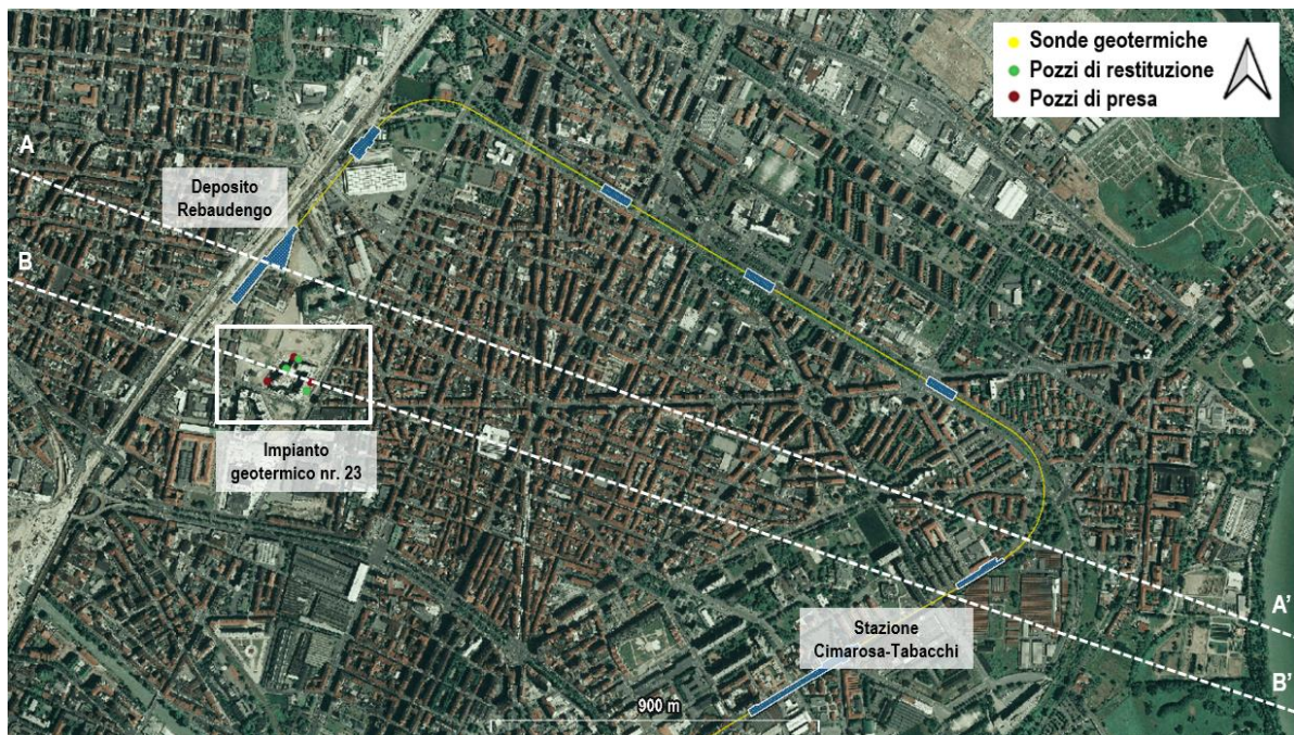
Figura 9. Area di Torino a Nord della Barriera di Milano, con indicazione del tracciato di Linea 2 e dell'impianto geotermico nr. 23. In planimetria è indicata la traccia delle sezioni A-A' e B-B' (Politecnico di Torino, 2023).
