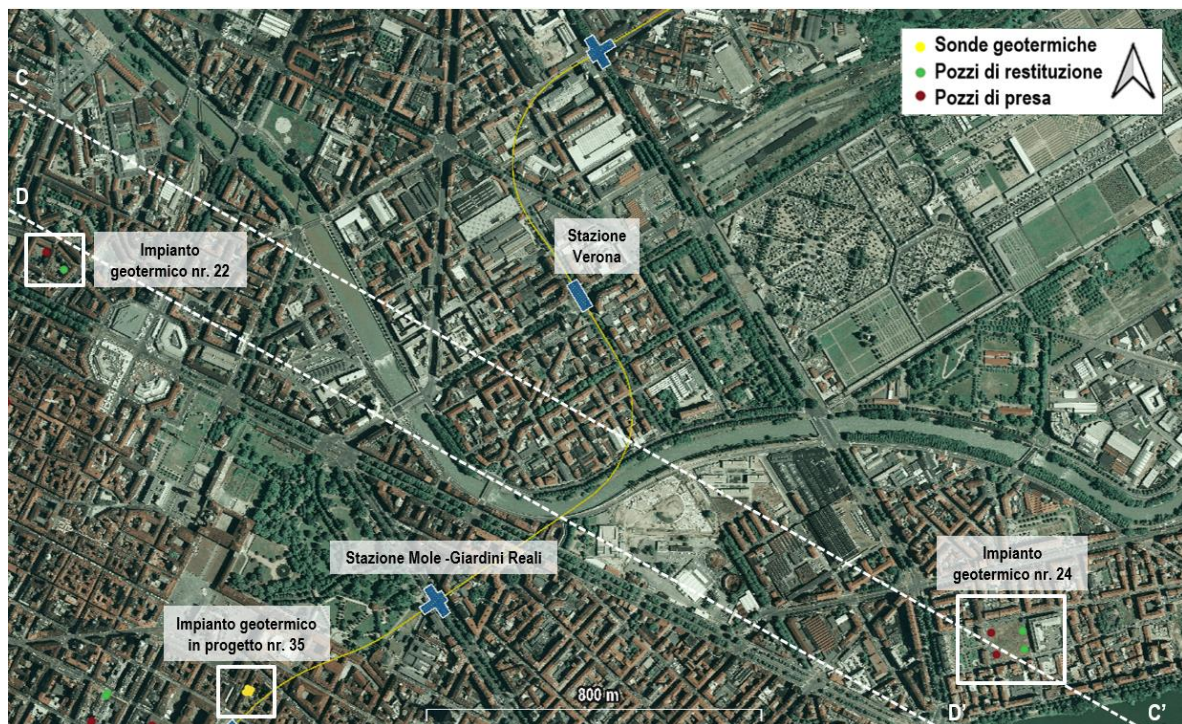
Figura 14. Inquadramento dell'area di Torino circostante al tracciato tra la stazione Verona e Mole-Giardini Reali. In planimetria sono indicate la traccia delle sezioni C-C' e D-D' e l'ubicazione gli impianti geotermici nr. 22, 24 e 35 (Politecnico di Torino, 2023).
