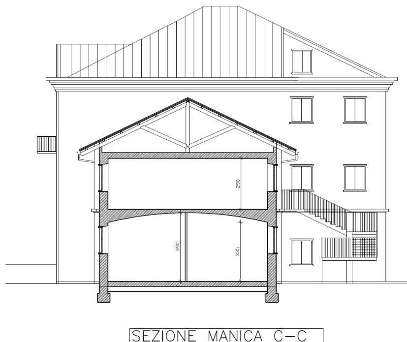
Figura 126 – Sezione trasversale manica edificio
