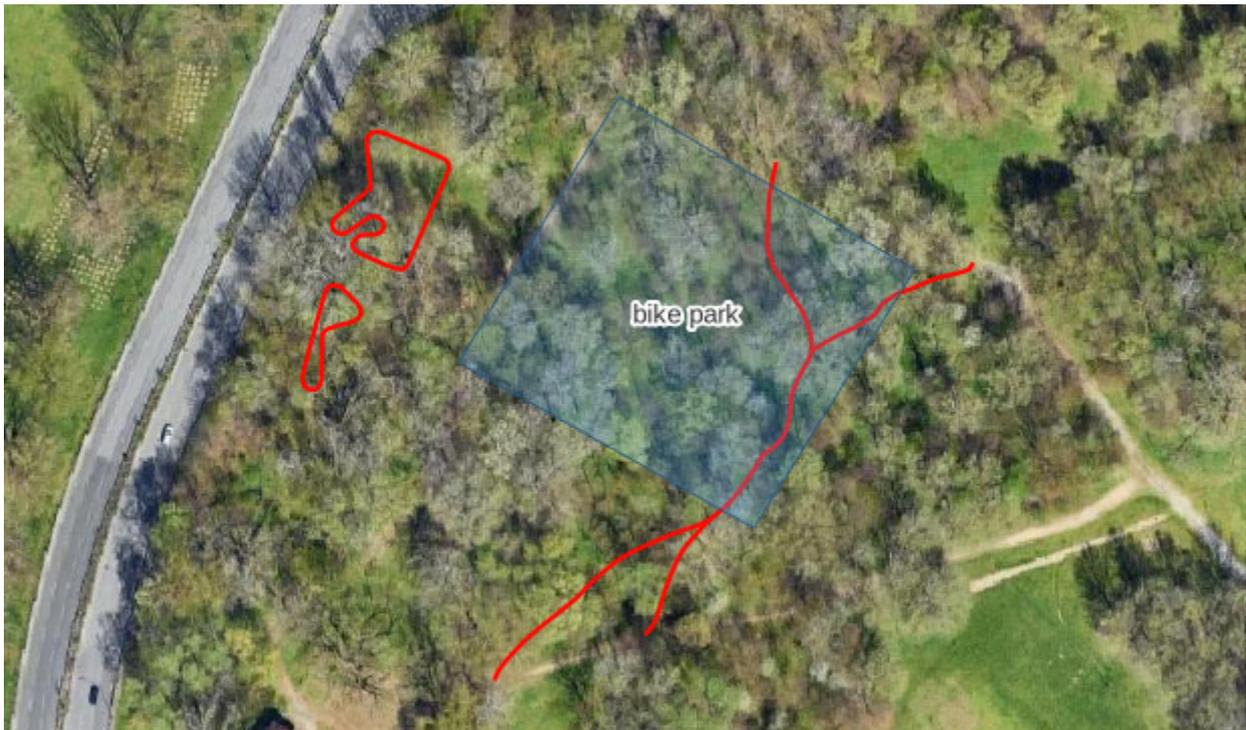
Data l'esigenza di indicare alla DL l'area dove andranno inseriti gli attrezzi che andranno a creare la pista per biciclette si è proceduto delimitando l'area tramite il rilievo di alcuni elementi noti: il sentiero (elemento lineare in rosso a destra nell'immagine) e due attrezzi del percorso fitness esistenti.
