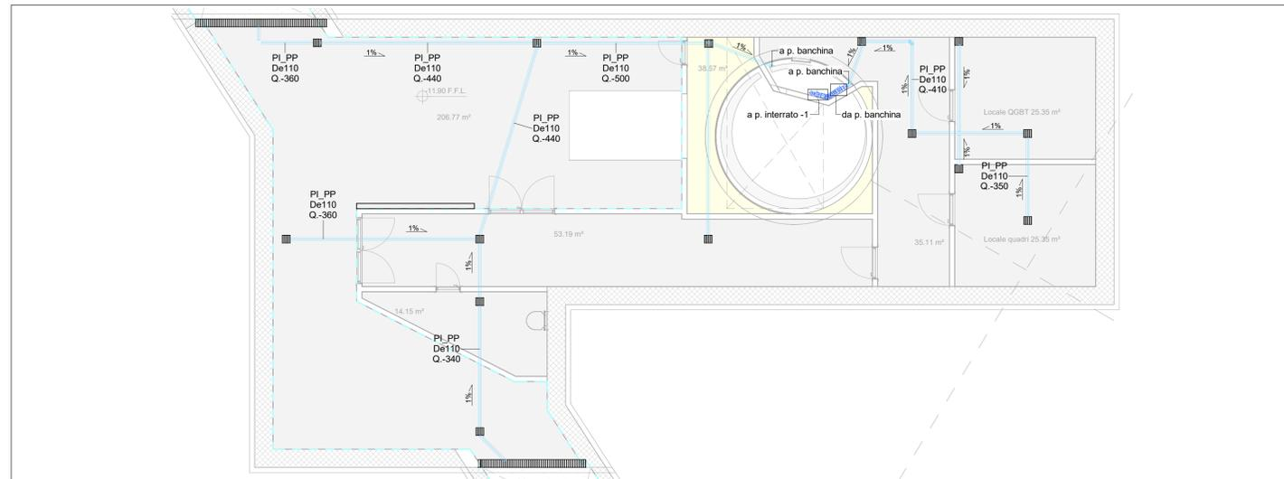
2 Piano secondo interrato - Impianto di scarico e aggotamento (livello -2)
