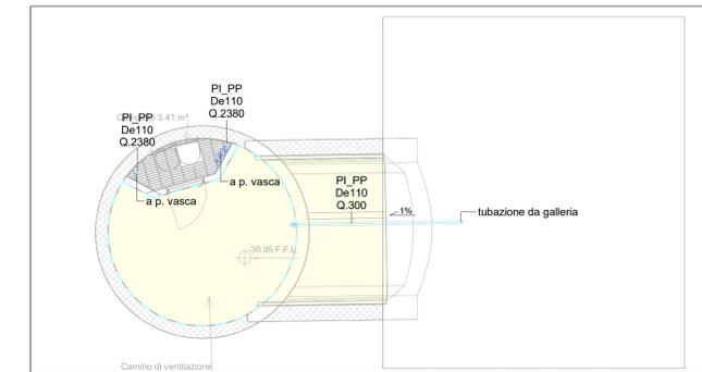
3 Piano banchina - Impianto di scarico e aggotamento (livello -3)
