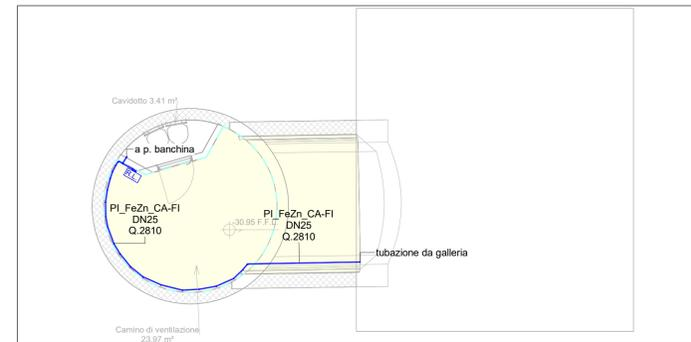
8 Piano banchina - Impianto idrico antincendio e idrico sanitario (livello -3)
