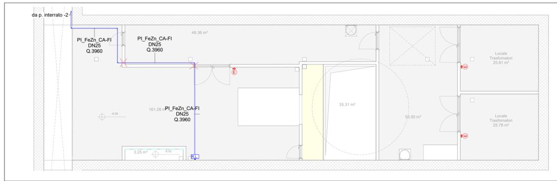
1 Piano primo interrato - Impianto idrico antincendio - idrico sanitario (livello -1)
