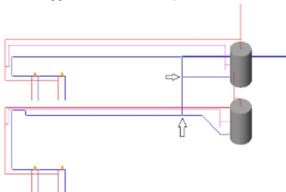
Le unità di carico vengono sommate dove i flussi si combinano nelle diramazioni dai diversi dispositivi idrici. Fanno eccezione i rami sul lato della radice degli scaldacqua dove si combinano i flussi di acqua calda e fredda dello stesso apparecchio.
