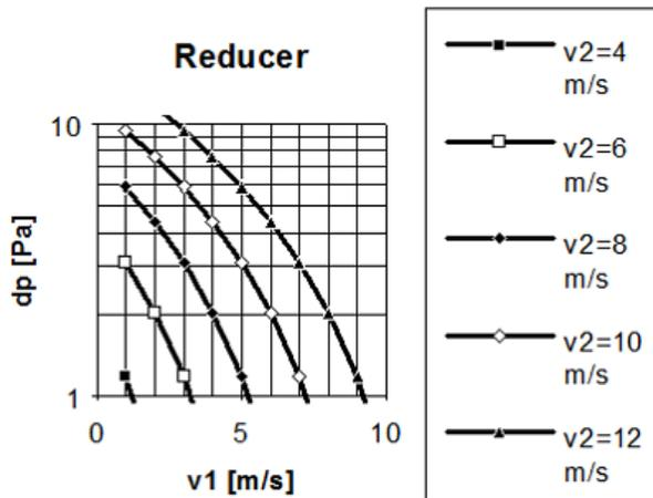
$$dp = 0,146 * (v_2 - v_1)^{1,9} \quad [Pa]$$
