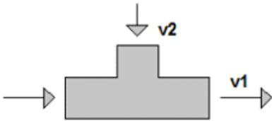
$$\text{Se } (v_1 \leq v_2) \Rightarrow dp = 0.58 \cdot v_2^2$$
