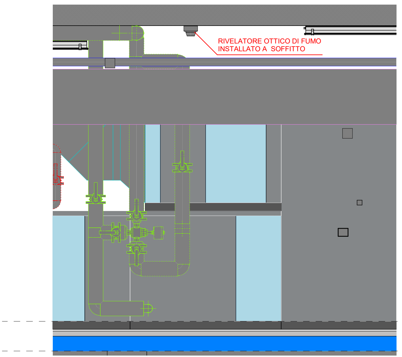
2 Sezione - Riv. Incendi Piano Copertura 1 : 20
