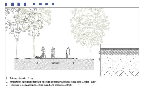
**SEZIONI DI DETTAGLIO - PERCORSI CICLOPEDONALI DI PROGETTO**
