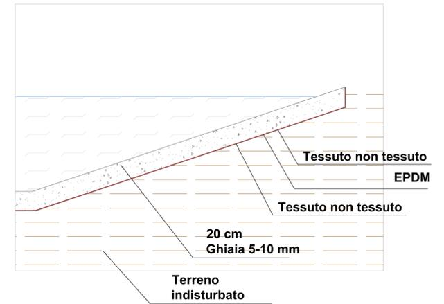
DETTAGLIO SCAVO SEZIONE A-A' scala 1:20
