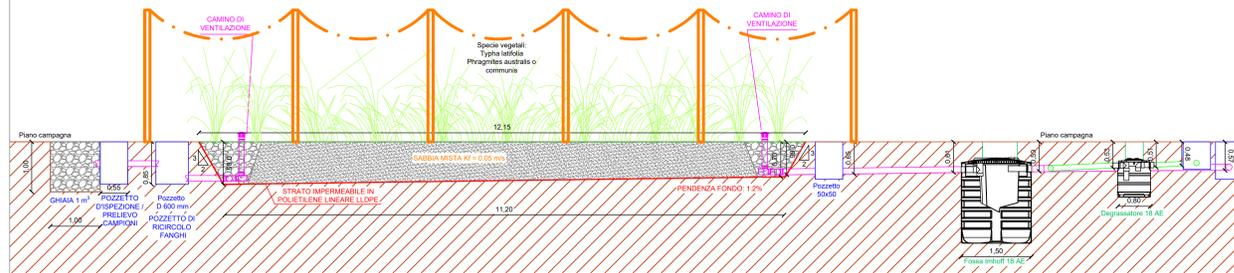
DETTAGLIO IMPERMEABILIZZAZIONE scala 1:10
