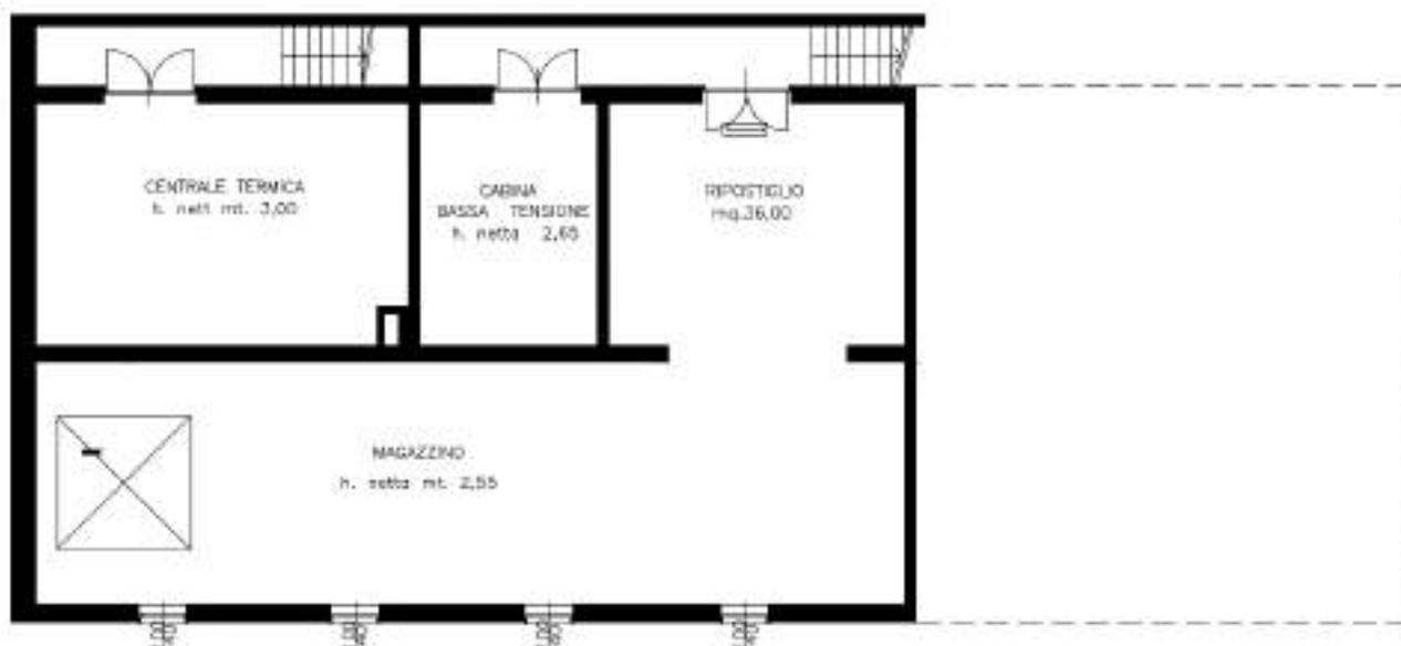
Figura 11 - Pianta piano seminterrato
