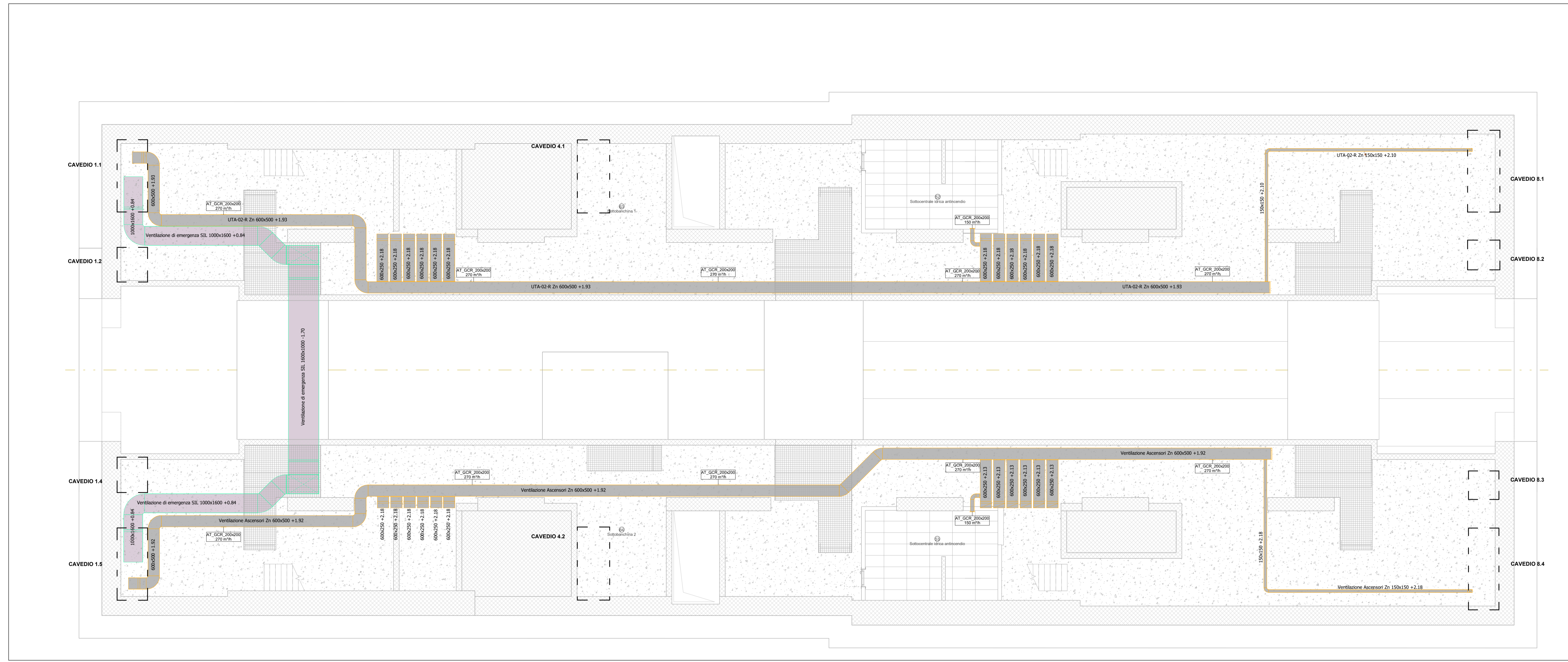
1 Impianto aerulico - Piano sottobanchine (livello -4) 1 : 100
