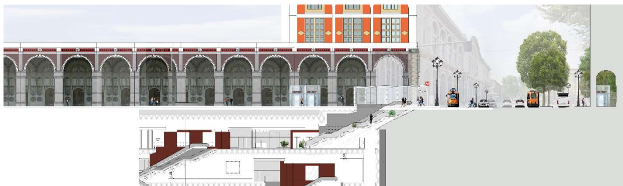
Figura 83. Sezione caratterizzata delle uscite della Stazione Porta Nuova – Vista su via Nizza verso la stazione
