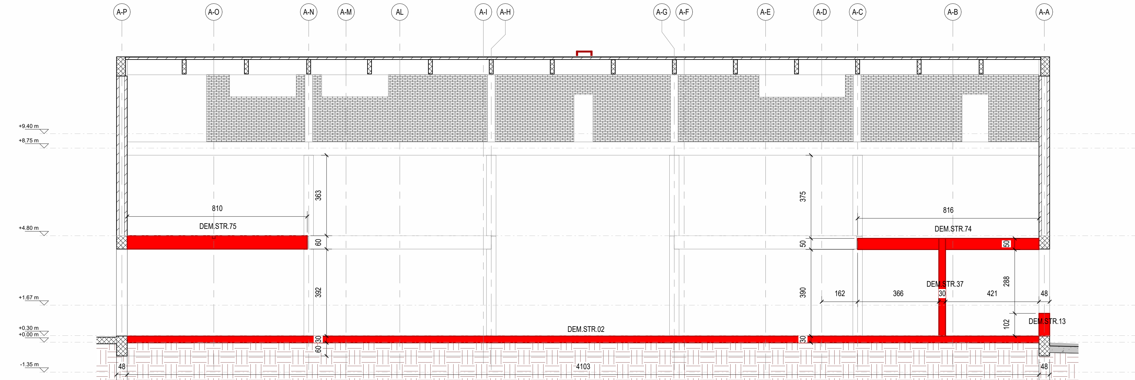
DEMOLIZIONI - ATRIO - Sezione AT-3
