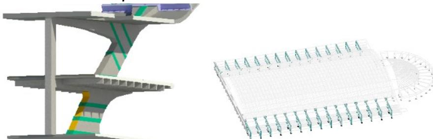
I *pilastroni* costituiscono il sostegno degli archi della volta ondulata, ricevendo ciascuno tre di essi tramite il *ventaglio*, e ne trasmettono il carico in fondazione. Su di essi si scaricano anche parte dei solai piani di copertura e l'orizzontamento del loggiato. Presentano una sezione variabile, crescente verso le fondazioni, ideata da Nervi per mantenere la risultante dei carichi nel terzo medio della fondazione. Presentano armature con scarso copriferro.
