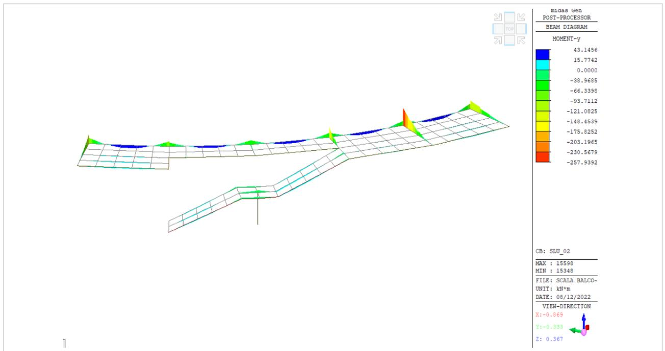
Figura 6 – Combinazione SLU - Diagramma momento flettente – dettaglio scala
