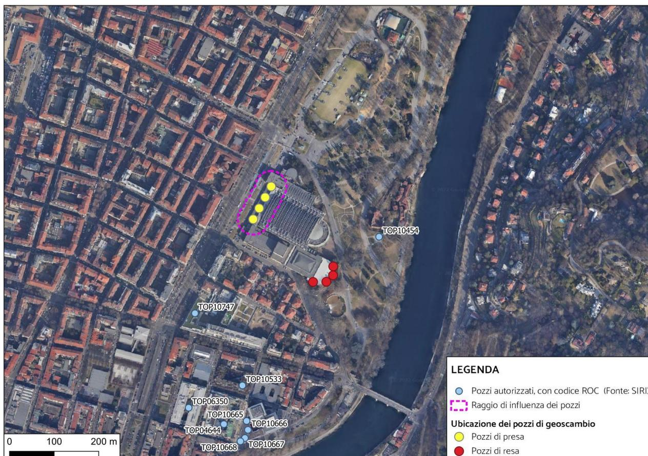
Figura 9: stralcio del “Sistema Informativo Risorse Idriche, con categorizzazione dei pozzi autorizzati con indicazione dell’area in cui sono ubicati i pozzi di presa e di resa in progetto
