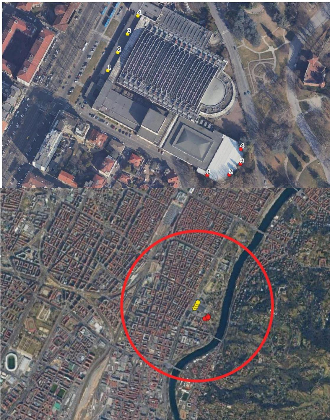
Figura 1: sistema in progetto di scambio geotermico a circuito aperto: giallo = pozzi di presa, rosso = pozzi di resa.
