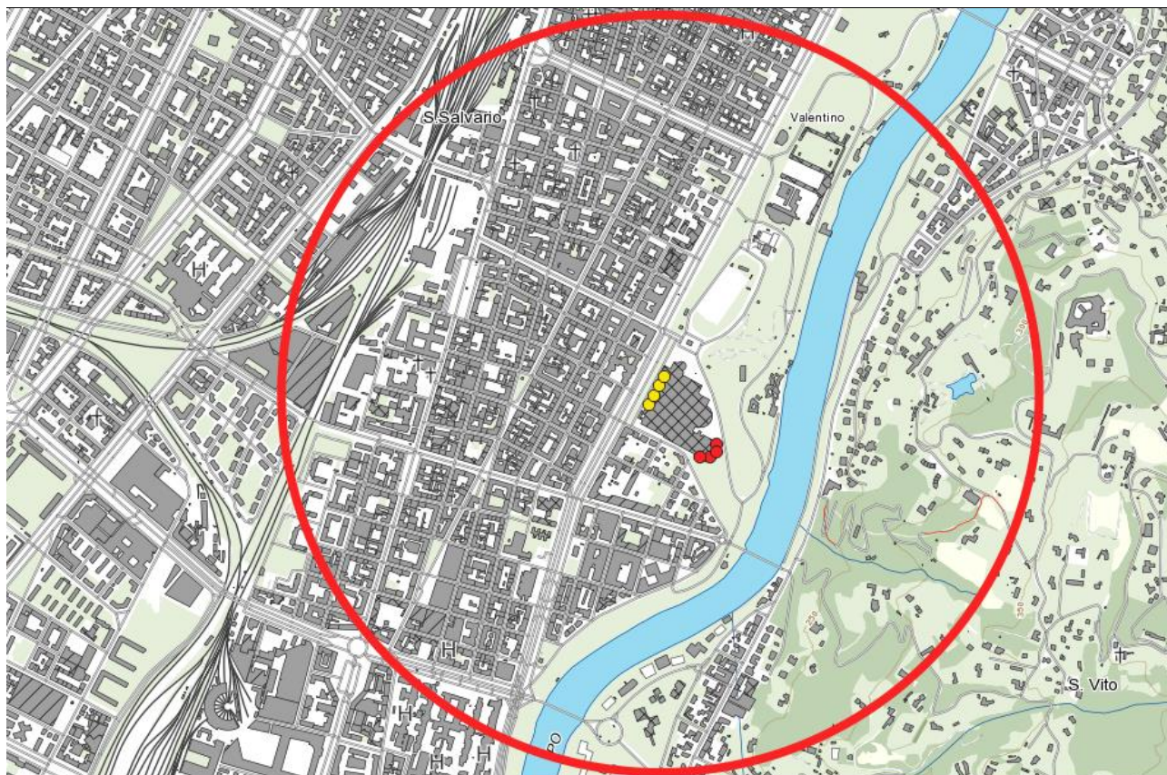
Figura 1: ambito di studio idrogeologico di dettaglio, perimetrato entro 1 km dal sito di progetto su sfondo base cartografica BD3 2022 – Regione Piemonte. Sistema in progetto di scambio geotermico a circuito aperto: giallo = pozzi di presa, rosso = pozzi di resa.
