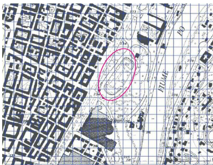
Figura 5 - Definizione dell'area di calcolo (griglia 3D) predisposta per l'attivazione del modello MODFLOW. La griglia consiste in 25 x 25 celle di 50 m di lato e di 3 strati (per un totale di 1875 celle).
