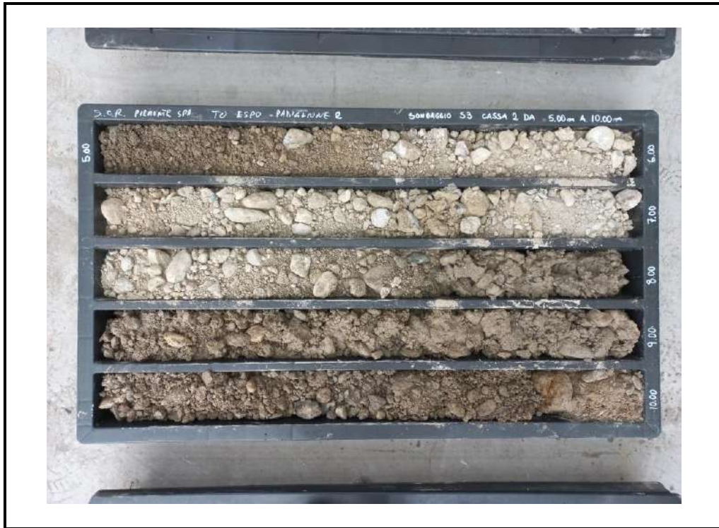
Foto 15: Sondaggio S3 - cassa 2 - da 5.00 m a 10.00 m.
