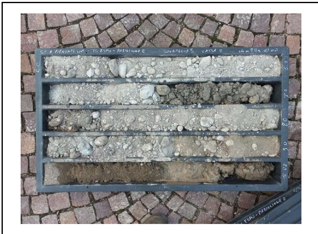
Foto 29: Sondaggio S5 - cassa 2 - da 5.00 m a 10.00 m.
