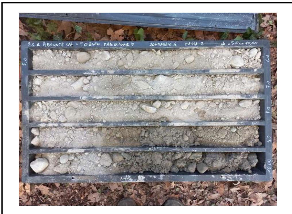
Foto 40: Sondaggio S4 - cassa 2 - da 5.00 m a 10.00 m.
