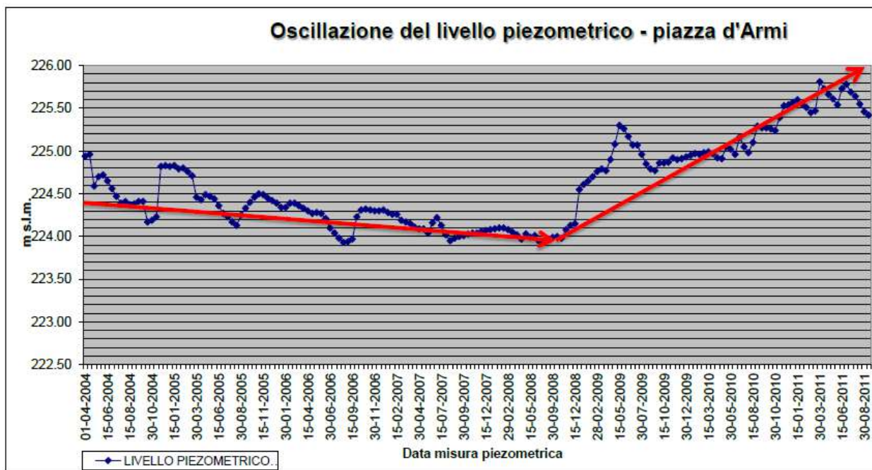
Figura 44: serie freaticometrica al piezometro registratore di Torino – P. zza d’Armi; periodo 2004-2011
