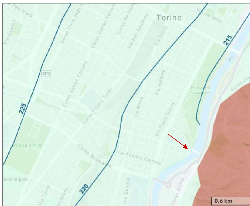
Figura 32: campo di moto della falda superficiale, città di Torino. Fonte: GEOportale ARPA Piemonte, idrogeologia . Inquadramento a scala di area vasta (sopra) e, nel riquadro, dettaglio relativo all'intorno del sito
