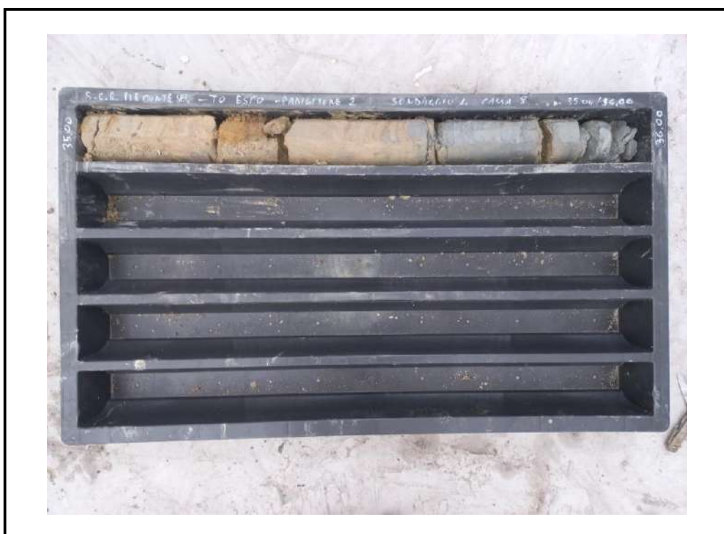
Foto 26: Sondaggio S4 - cassa 8 - da 35.00 m a 36.00 m.
