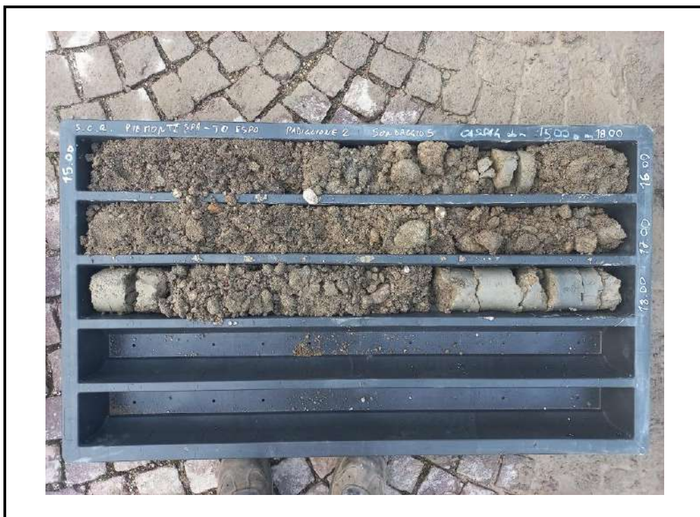
Foto 31: Sondaggio S5 - cassa 4 - da 15.00 m a 18.00 m.
