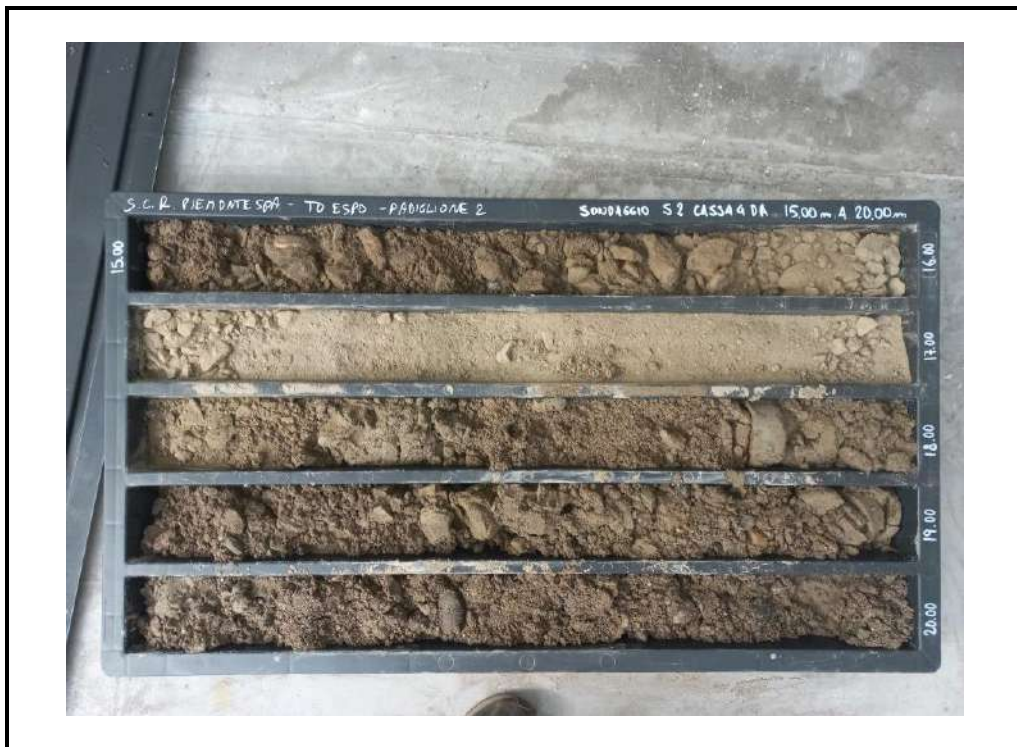
Foto 12: Sondaggio S2 - cassa 4 - da 15.00 m a 20.00 m.
