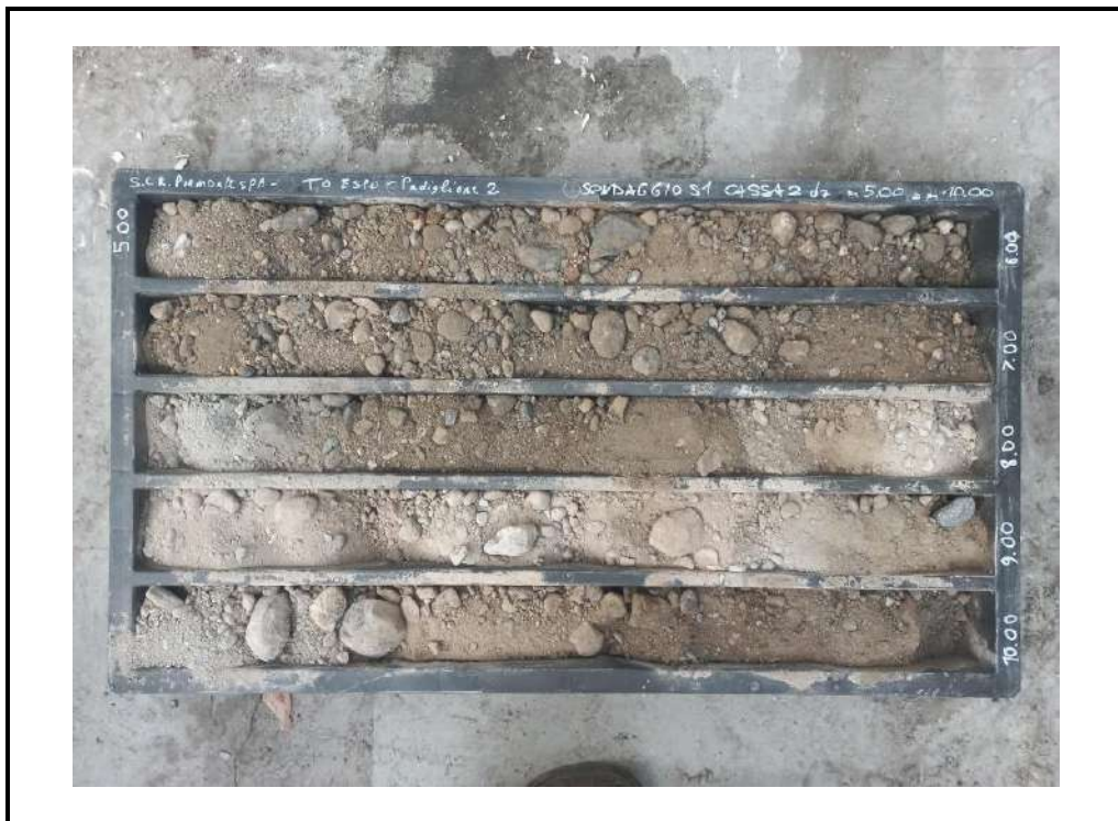
Foto 2: Sondaggio S1 - cassa 2 - da 5.00 m a 10.00 m.
