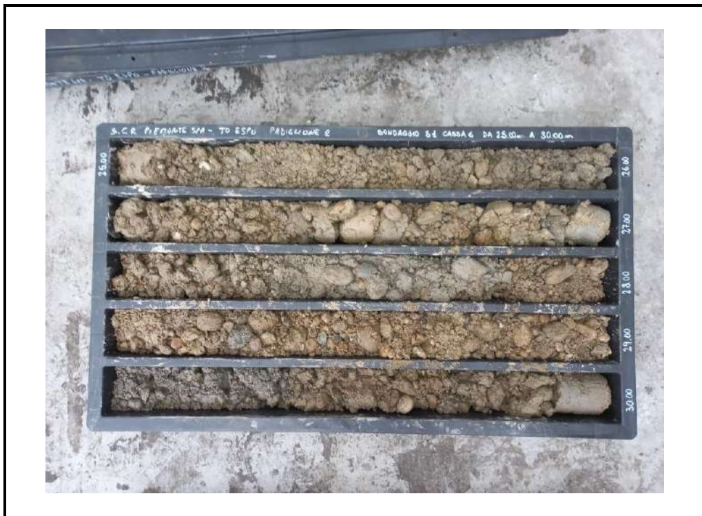
Foto 6: Sondaggio S1 - cassa 6 - da 25.00 m a 30.00 m.
