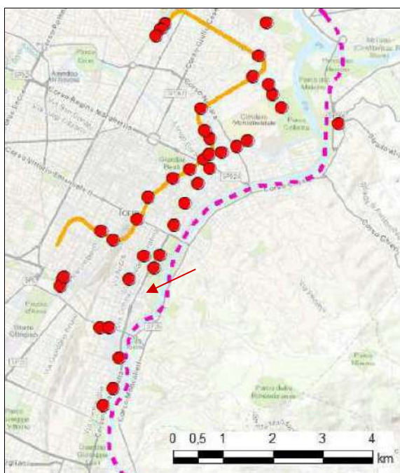
Figura 26: ubicazione dei sondaggi considerati per l'aggiornamento della cartografia della B.A.S. nel comune di Torino, presso il sito di progetto.
